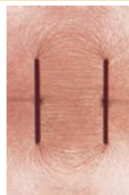
شکل ۱۹-۱ سمت گیری دانه‌ها در فضای بین دو الکتروده صفحه‌ای موازی
