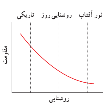
شکل ۲-۲ مقاومت بر حسب روشنایی برای یک LDR نوعی
