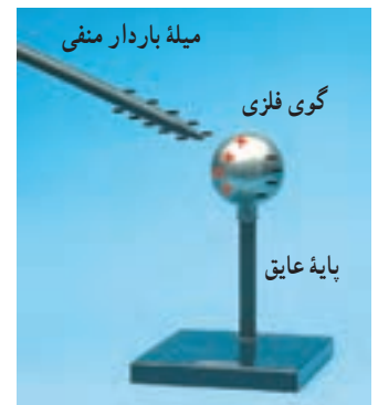
شکل ۲۹- بار اضافی داده شده به یک رسانا در سطح خارجی آن توزیع می‌شود.
