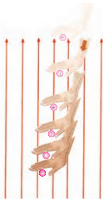
شکل ۱۲-۱ نیروی دست، بار +q را در خلاف جهت میدان الکتریکی جابه‌جا می‌کند.
