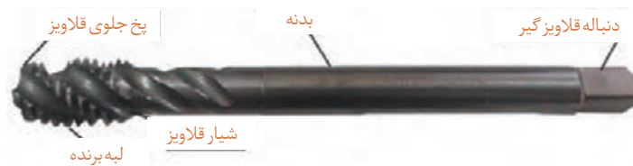
شکل ۲- ساختمان قلاویز ماشینی
