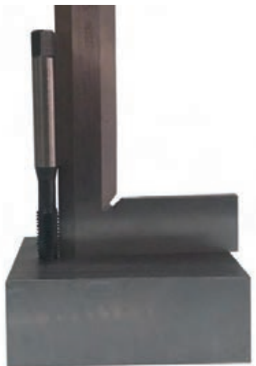
شکل ۷- کنترل عمود بودن قلاویز با سوراخ
