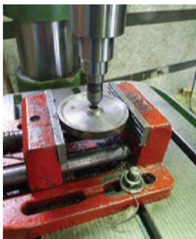
شکل ۹- استفاده از مرغک در ایجاد هم‌مرکزی صحیح
