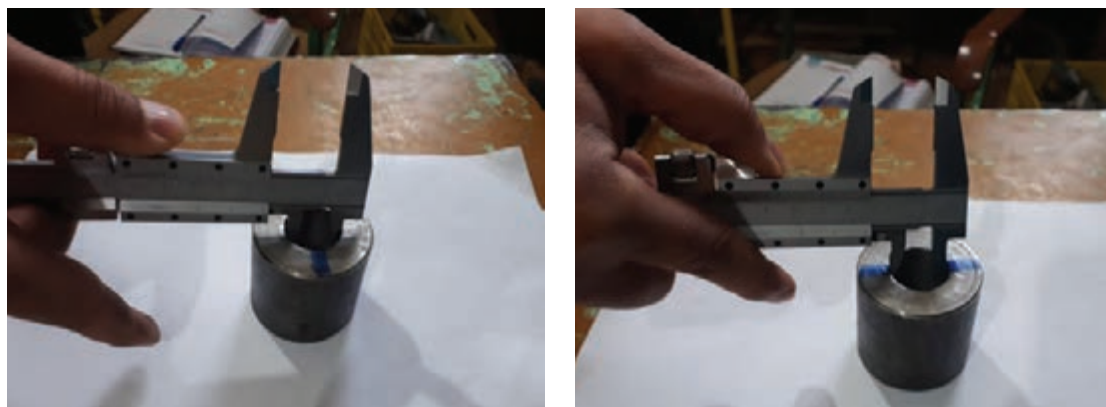
شکل ۱۵- کنترل دایره ای بودن سوراخ
