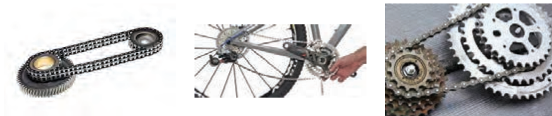
شکل ۲۱- مکانیزم‌های چرخ زنجیری
