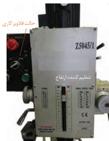
شکل ۴- کُلگی قلاویز ماشینی با قابلیت تنظیم ارتفاع
