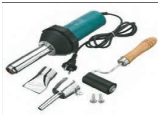
شکل ۱۰- ابزار جوشکاری با گاز داغ
