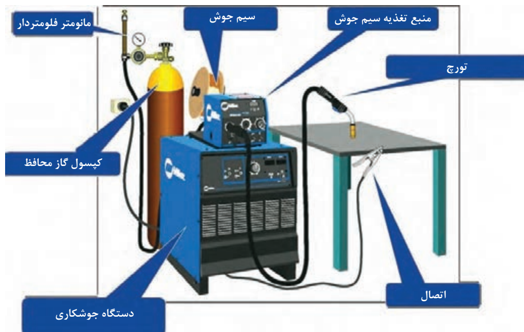
شکل ۶- قسمت های مختلف دستگاه جوشکاری FCAW
