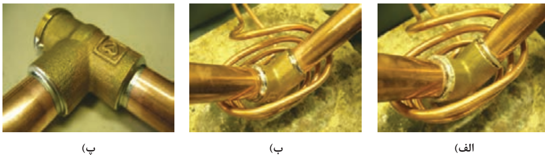
شکل ۵- مراحل ایجاد لحیم با استفاده از فیلرهای حلقوی الف) مونتاژ، ب) لحیم کاری و پ) محصول نهایی
