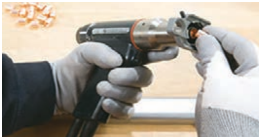
شکل ۲۰- قرار دادن محافظ سرامیکی
