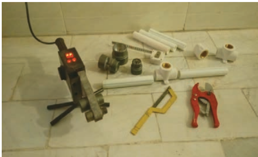
شکل ۱۹- تجهیزات جوشکاری لوله‌های پلاستیکی
