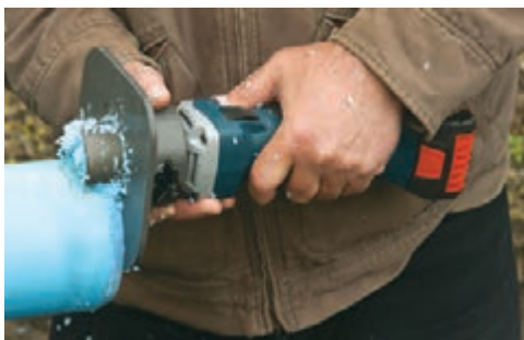
شکل ۲۴- پخ زدن قطعات پلاستیکی برای جوشکاری
