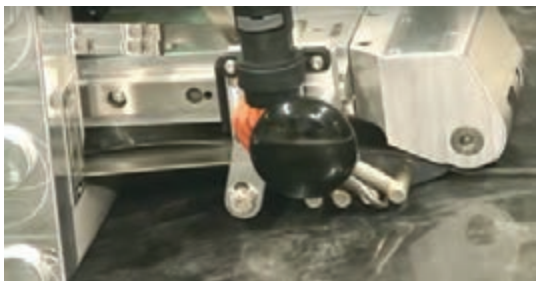
شکل ۶- جوشکاری با گوه داغ (Hot Wedge) و دستگاه جوش آن
