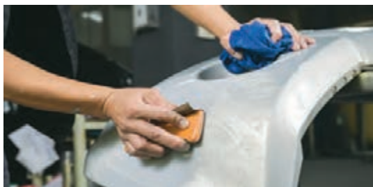
شکل ۳۰- پولیش قطعه کار پس از تعمیر
