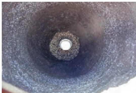
شکل ۲۰- استقرار دیسک ذوب شونده در انتهای بوته
