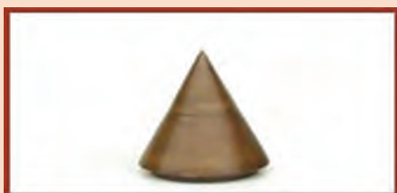
شکل ۱۰- قطعه مخروطی برای باز دهانه لوله
