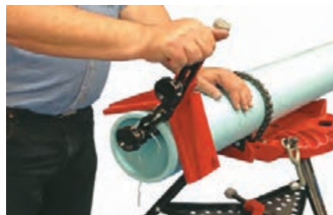
شکل ۲۴- پخ زدن قطعات پلاستیکی برای جوشکاری
