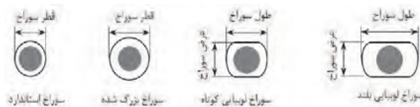
شکل ۹۹ ▲ انواع سوراخ پیچ‌ها در اتصالات پیچی
