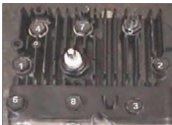
شکل ۳۴- ترتیب بستن پیچ‌های سرسیلندر
