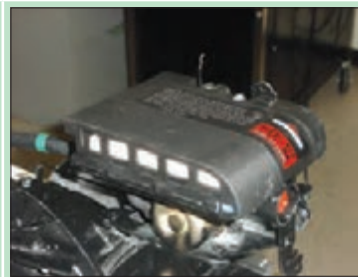
۴- در پوش فیلتر هوا را باز کنید.
