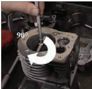
شکل ۲۸- کنترل دو پهنی سیلندر
