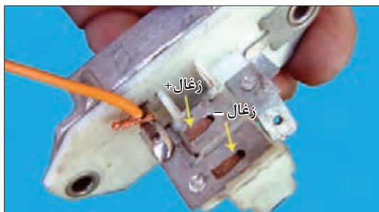
الف) وصل کردن یک سیم به زغال منفی
