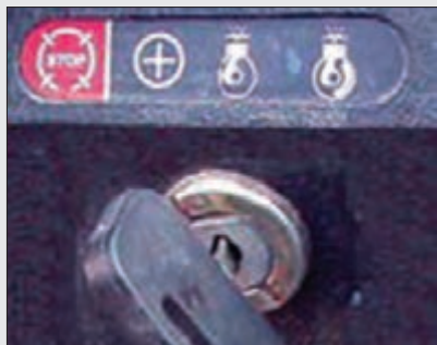
شکل ۹- مراحل سوئیچ تراکتور MF399
