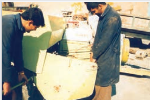
شکل ۳۳- جدا کردن واحد بردارنده
