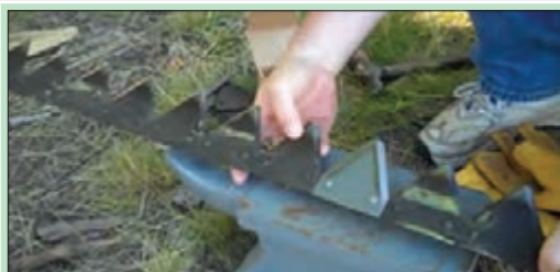
۶- وضعیت تیغه و پرچ‌ها را بررسی کنید.
