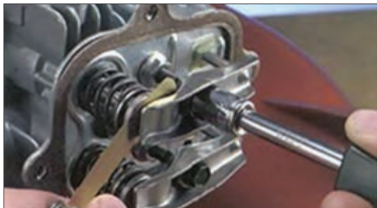
شکل ۳۵- فیلر کردن سوپاپ
