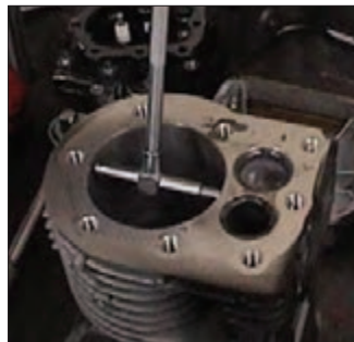
شکل ۲۸- کنترل دو پهنی سیلندر
