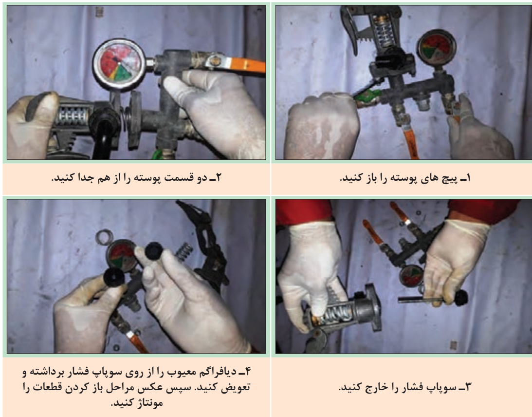
شکل ۵۲- تعویض دیافراگم رگولاتور مدل کمت
