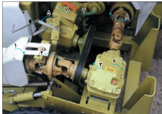
شکل ۱- اجزای انتقال قدرت به واحدهای کاری چاپر دو ردیفه
