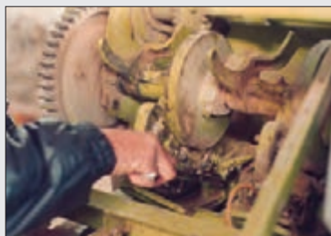
شکل ۴۴- باز کردن کفشک گره زن
