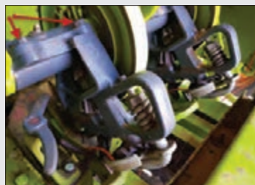
شکل ۴۵- پیچ‌های پوسته گره زن
