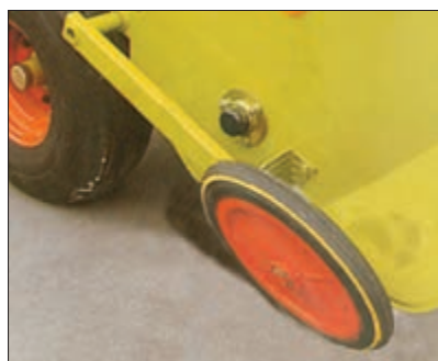
شکل ۲۸- چرخ تنظیم کج شده
