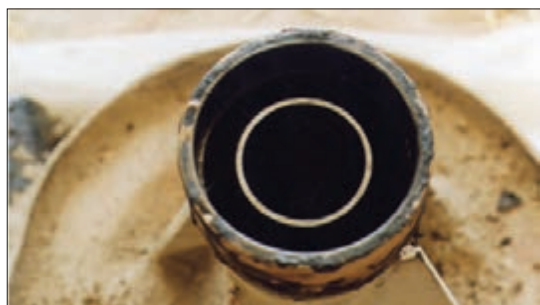
شکل ۴۳- ساییدگی جای بلبرینگ
