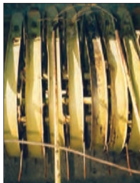
شکل ۲۲- تسمه ساییده و کج شده
