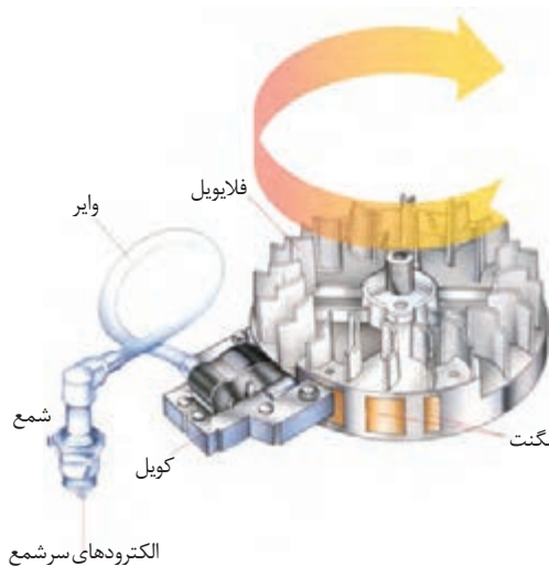
شکل ۷- طرز کار سیستم جرقه‌زنی
