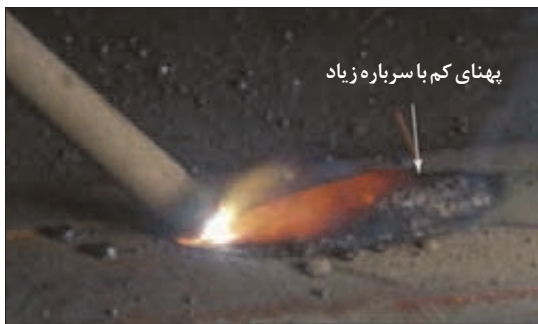
شکل ۳۰- جوشکاری با طول قوس بسیار کم
