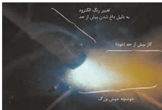
شکل ۲۷- جوشکاری با آمپر بسیار بالا
