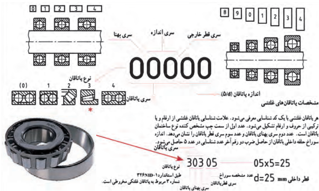
شکل ۵۵- نحوه استخراج مشخصات بلبرینگ از روی شماره فنی آن
