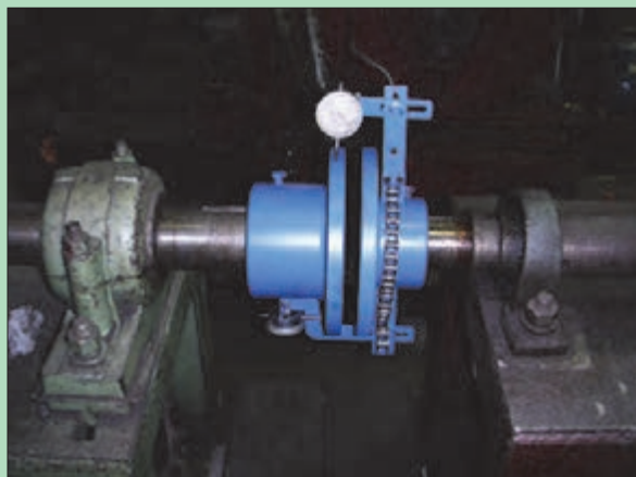
شکل ۷۷- هم‌راستا کردن محورها با ساعت اندازه‌گیری
