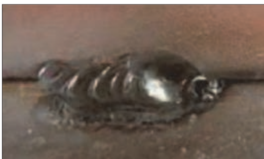
شکل ۴- مقطع باید کوچک و یکنواخت باشد تا تأثیری بر جوش نهایی نداشته باشد
