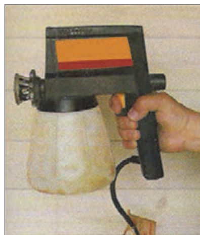
شکل ۶۱- پیستوله بدون کمک هوای فشرده (Airless)
