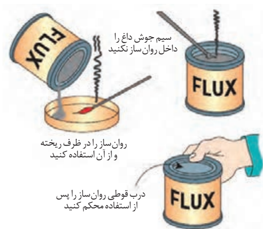
شکل ۲۸- روش استفاده از روان ساز
