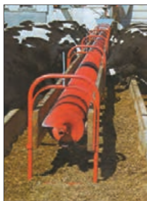
شکل ۲۲- توزیع خوراک به وسیله نقاله پیچی
