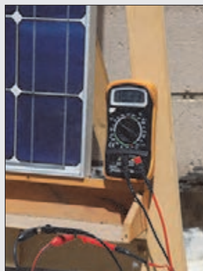
شکل ۲۲- اندازه‌گیری ولتاژ بی‌باری
