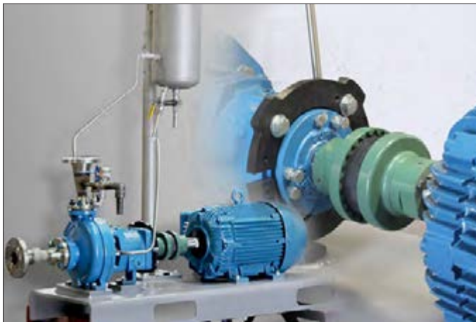
شکل ۸- انتقال قدرت مستقیم از موتور به دستگاه
