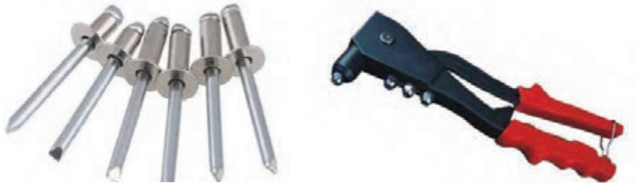
شکل ۳۹- میخ پرچ آلومینیومی و انبر پرچ کن
