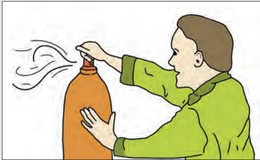
شکل ۱۳- روش تمیز کردن محل اتصال کپسول
