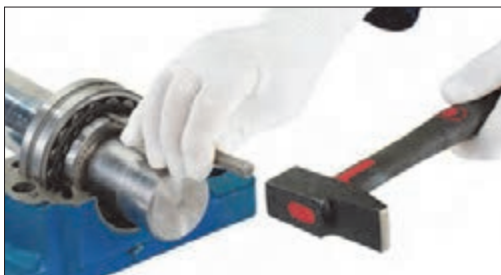
شکل ۶۲- جدا کردن بلبرینگ از بوش مخروطی
