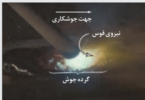
شکل ۳۹- جوشکاری با زاویه پیشران
