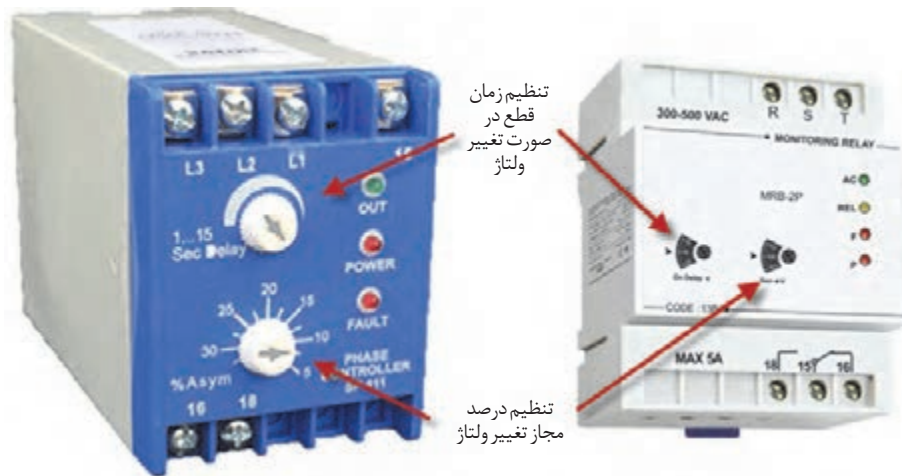
شکل ۲۳- دو نوع کلید کنترل فاز
