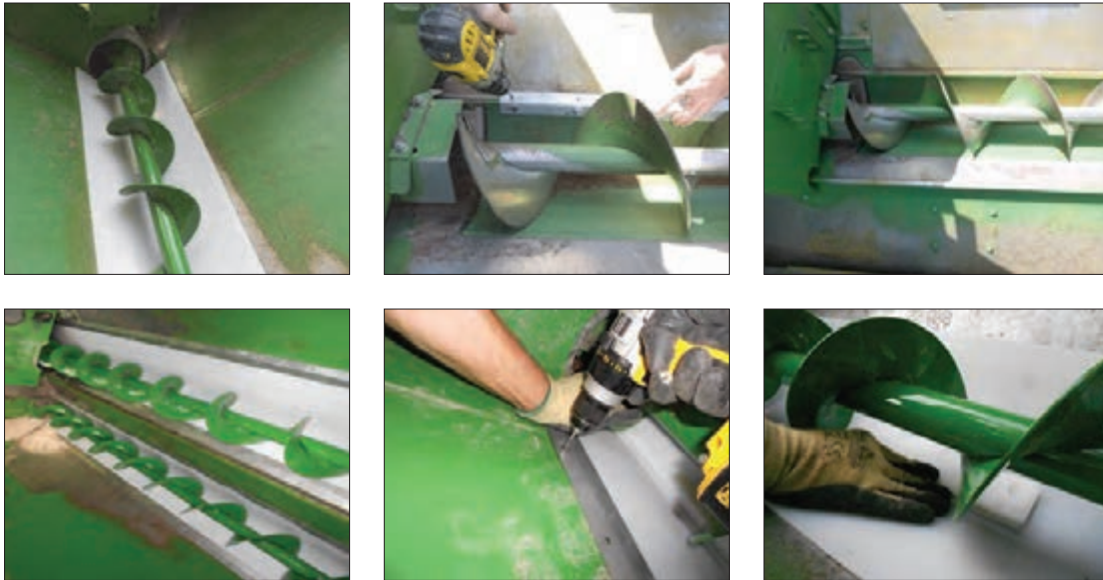
شکل ۳۵- تعمیر محفظه زیرین هلیس مخزن کمباین
