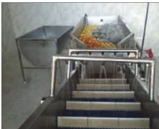
شکل ۴۰- ماشین شست‌وشوی تسمه‌ای
