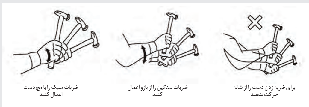
شکل ۵۰- روش ضربه زدن با چکش
