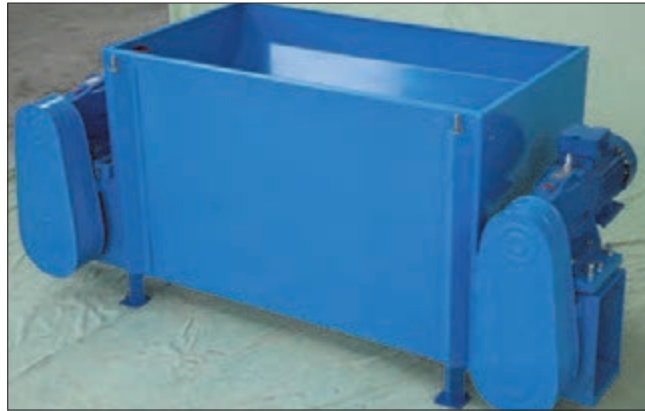
الف) تغییر دور موتور با جعبه دنده در دانخوری زنجیری
