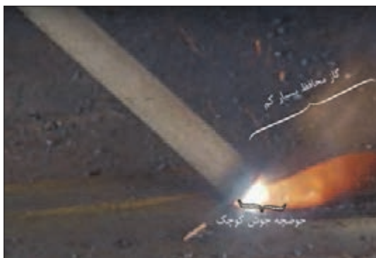
شکل ۲۶- جوشکاری با آمپر بسیار پایین
