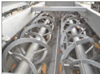
شکل ۸- مخلوط‌کن افقی و مارپیچ‌های آن
