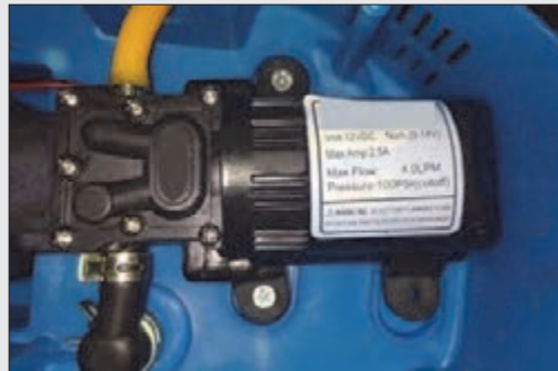
شکل ۳۲- اتصال پمپ و رعایت جهت حرکت سیال
