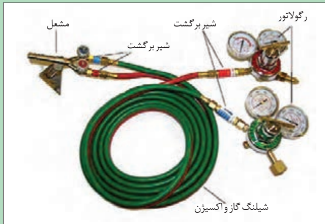
شکل ۱۸- محل نصب سوپاپ‌های یک طرفه (شیر برگشت)
