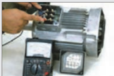
شکل ۶- آزمایش الکتروموتور با استفاده از مولتی متر
