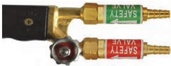
شکل ۱۰- شیر یک طرفه شعله گیر
