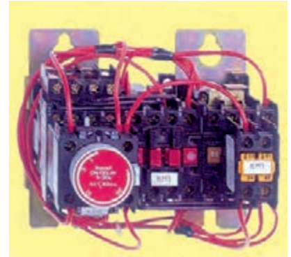
ب) تایمر پنوماتیکی نصب شده روی کنتاکتور شکل ۲۶۳
