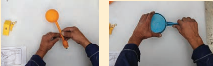
نحوه تنظیم انواع شناور
