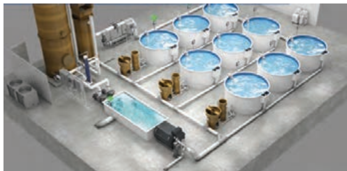
سیستم چرخش آب در پرورش ماهی
