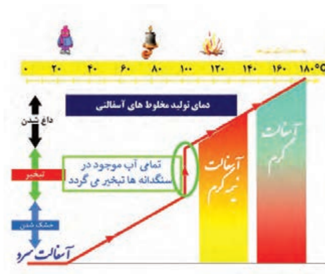
شکل ۲۷- دسته‌بندی آسفالت براساس دمای تولید آسفالت
