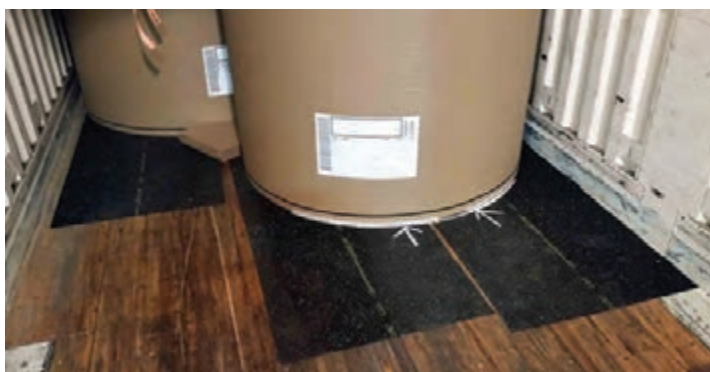
شکل ۱۴- نمونه‌ای از لایه‌های افزاینده اصطکاک
