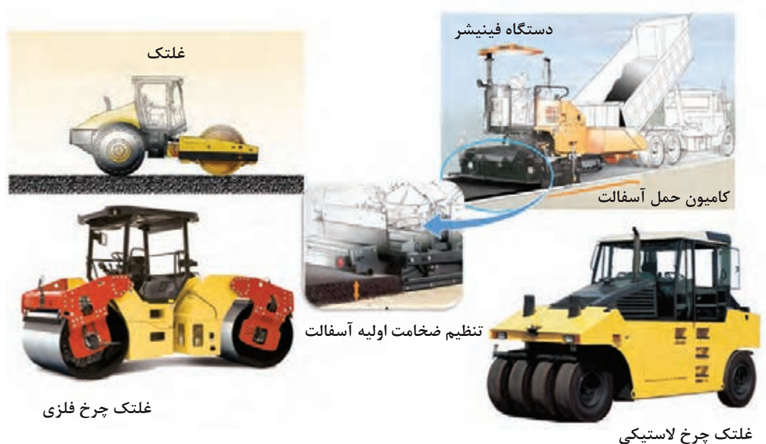
شکل ۳۲ - تجهیزات پخش و تراکم آسفالت
