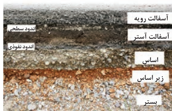
شکل ۲۰- لایه‌های مختلف یک روسازی آسفالتی
