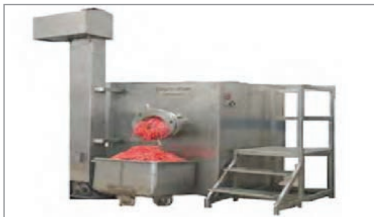
شکل ۵- دستگاه گیوتین چرخ گوشت
