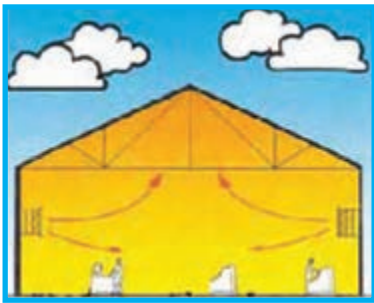
تصویر ۱-۲- مقایسه‌ی سیستم‌های گرمایشی جابه‌جایی و تابشی
