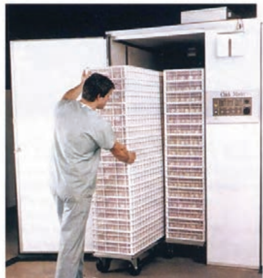
تصویر ۴-۲- انواع دستگاه تفریخ
