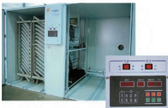
تصویر ۳-۲- انواع دستگاه جوجه‌کشی (ستر) بزرگ
