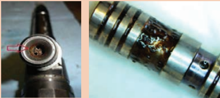
شکل ۴۵- خرابی انژکتور در اثر بودن آب در سوخت
