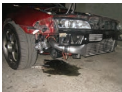
شکل ۴۹- یک نوع نشستی سیستم سوخت‌رسانی
