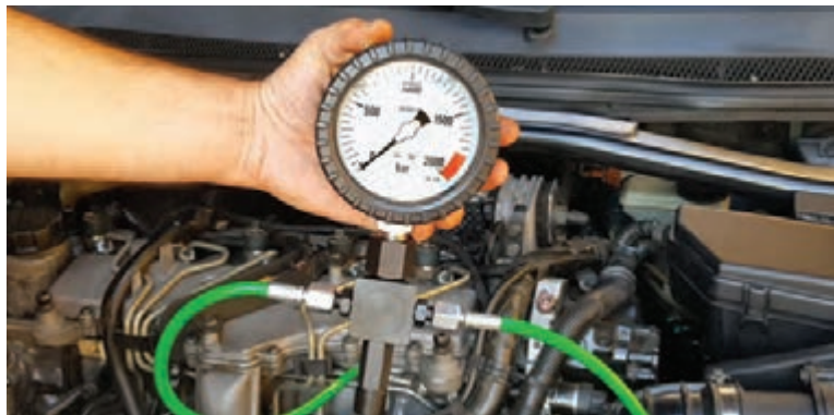
شکل ۵۲- بررسی فشار مدار سوخت‌رسانی دیزل با ابزار اندازه‌گیری
