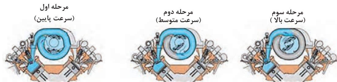
شکل ۳۷- عملکرد سیستم مانیفولد متغیر
