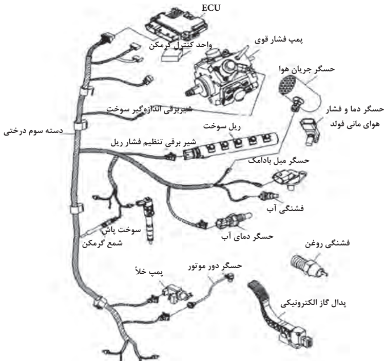
شکل ۲۷- نقشه درختی دسته سیم در یک نوع سیستم سوخت‌رسانی ریل مشترک
