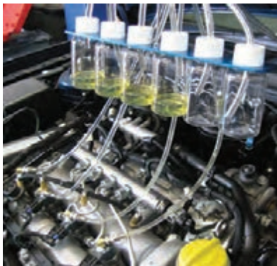
شکل ۴۰- تست اندازه گیری مقدار سوخت برگشتی انژکتورها
