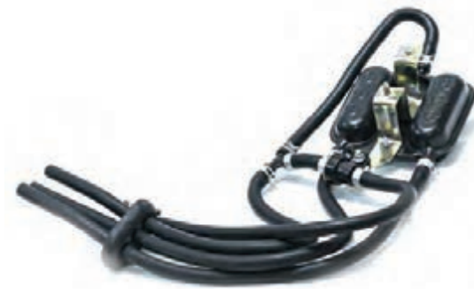
شکل ۶- ساختمان سیستم حباب گیر بنزین
