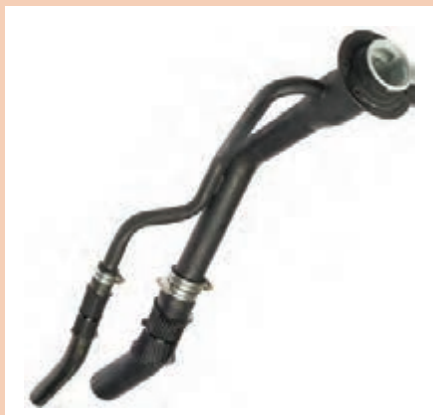
شکل ۳۷- لوله فلزی ورودی و مجرای کناری
