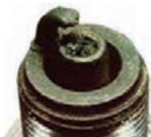
شکل ۳- آسیب به شمع بر اثر خودسوزی
