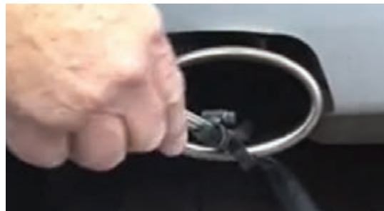
شکل ۳۴- روش درست بستن حسگر دستگاه آزمایش گاز در اگزوز خودرو
