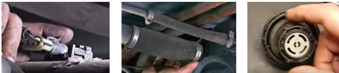
شکل ۹۴- برخی مراحل بررسی و سرویس یک نوع مخزن سوخت
