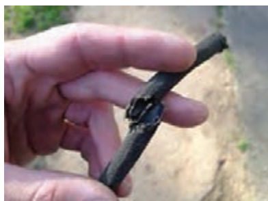
شکل ۴۹- یک نوع نشستی سیستم سوخت‌رسانی
