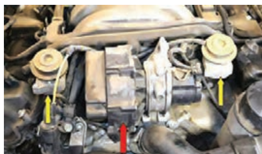
شکل ۴۸- بررسی‌های اتصالات مکانیکی، الکتریکی و خلأئی پمپ دمنده
