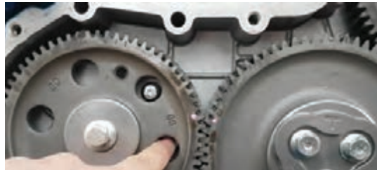
شکل ۵۳- بررسی تایم پاشش سوخت از روش اتصال پمپ به موتور
