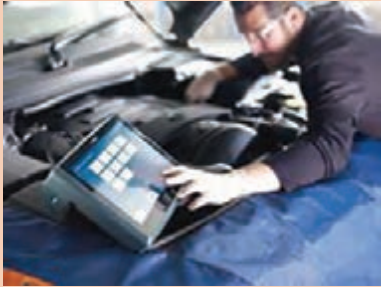
شکل ۳۹- کاربرد دستگاه عیب یاب
