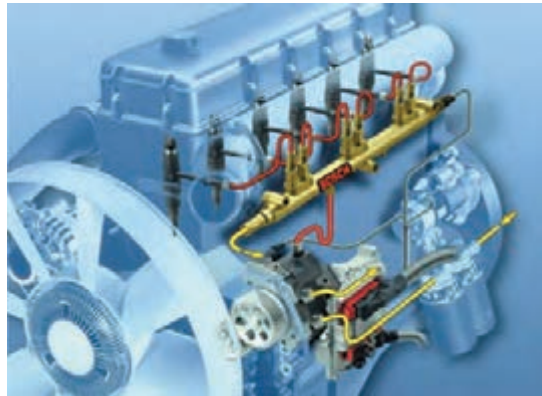
شکل ۴- اجزای سیستم سوخت‌رسانی ریل مشترک
