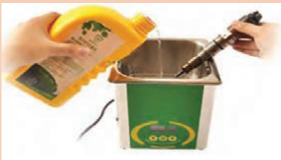
شکل ۸۳- تمیز کردن سوراخ انژکتور با دستگاه اولتراسونیک
