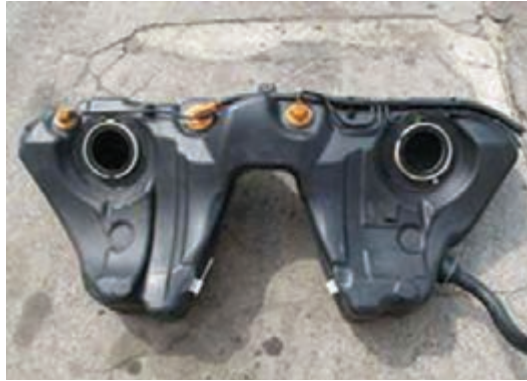
شکل ۷- مخزن سوخت با سوپاپ واژگونی
