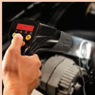
شکل ۲۱- روش کاربری چراغ تایمینگ
