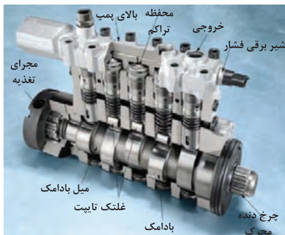
شکل ۱۰- یک نمونه پمپ انژکتور ردیفی
