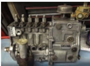
شکل ۵۷- برخی از مراحل باز کردن و بستن پمپ انژکتور ردیفی روی خودرو
