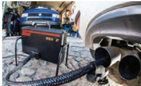
شکل ۵۴- قراردادن لوله دستگاه کنترل آلاینده‌گی درون لوله‌اگزوز
