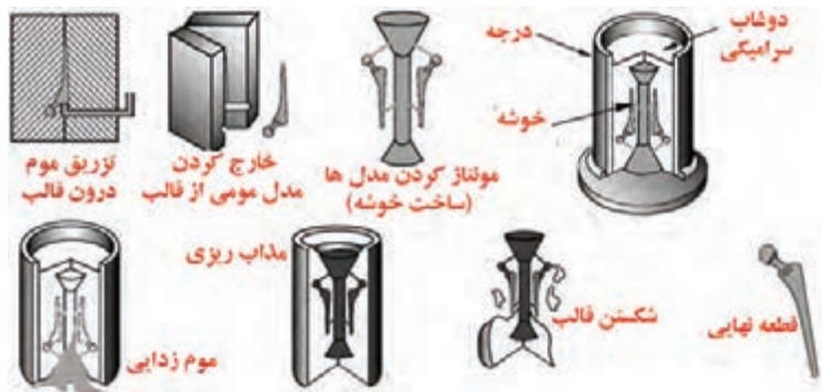
شکل ۲۳- مراحل مختلف ریخته‌گری دقیق به روش توپر
