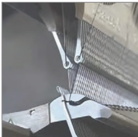
شکل ۳۷- مرحله ۱ قرارگرفتن حلقه روی ساقه سوزن
