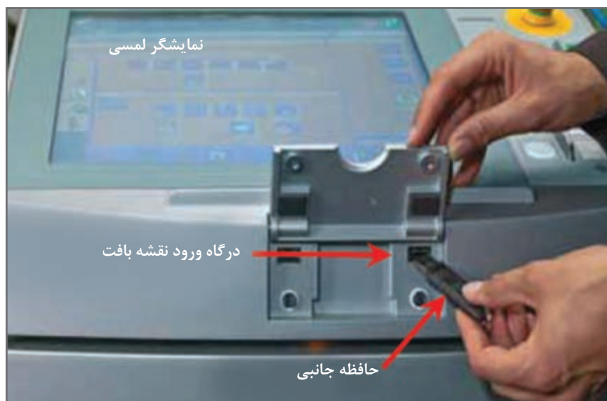
شکل ۳۵- نحوه اتصال حافظه جانبی به ماشین بافندگی
