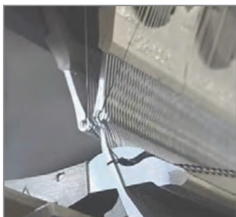
شکل ۳۹- حرکت سوزن از بین شانه‌ها
