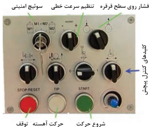
شکل ۱۲ - کلیدهای راه‌اندازی یک دستگاه پیچش قرقره
