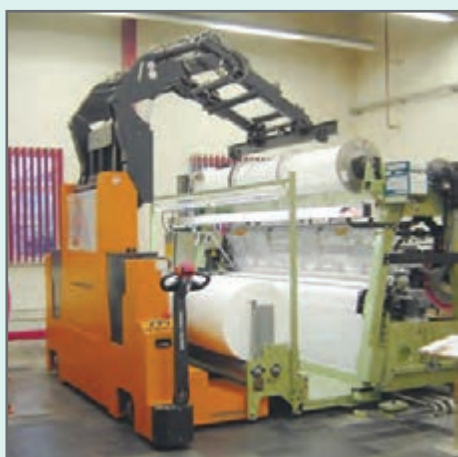
شکل ۱۹ - نحوه انتقال نورد حاوی قرقه‌ها روی ماشین
