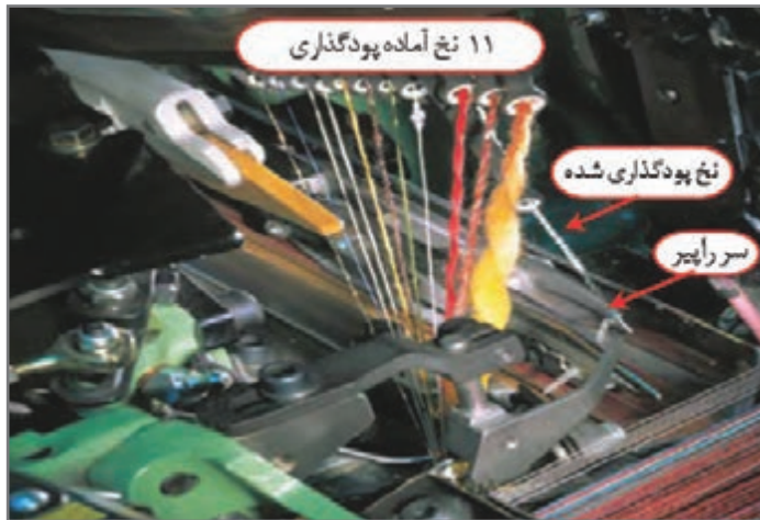
شکل ۲۰- سیستم تغییر پود در پودگذاری راپیری
