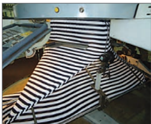
شکل ۵۰- برداشت پارچه به صورت برش خورده و صاف
