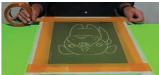
شکل ۱۴- نحوه چسب زدن پشت توری
