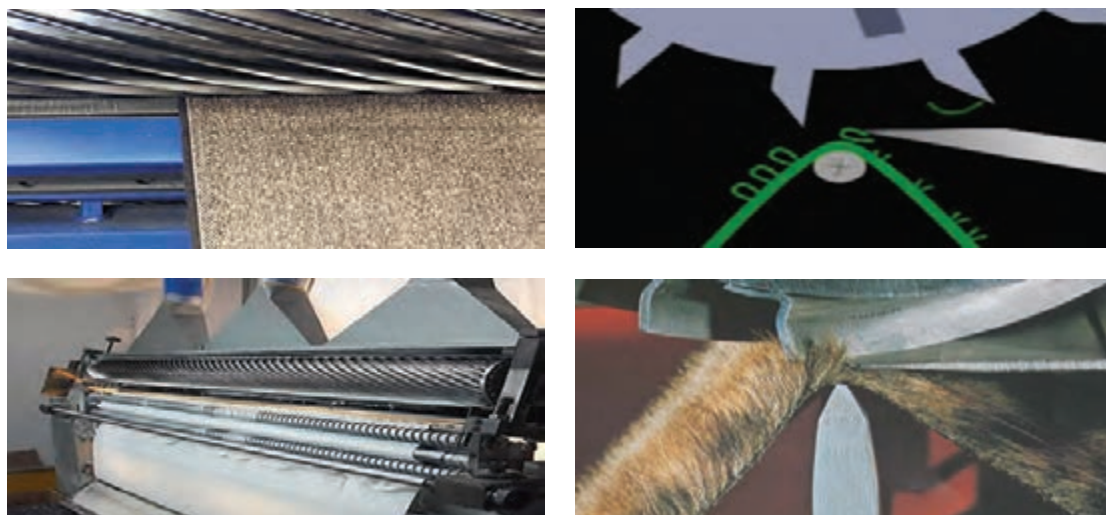
شکل ۱۰- تصویر تیغه مارپیچی و ماشین تراش پارچه
