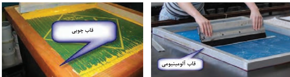
شکل ۵- نمونه‌ای از قاب آلومینیومی و قاب چوبی
