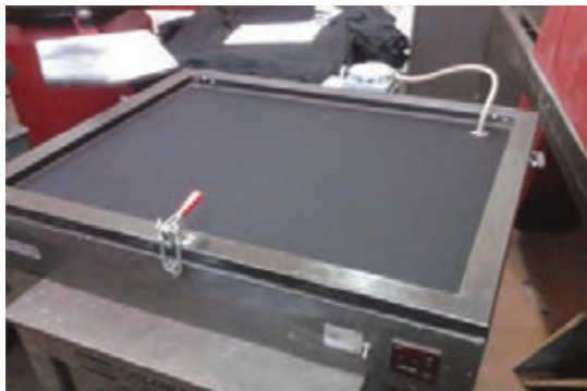
شکل ۱۳- میز نور با مکانیزم مکش هوا
