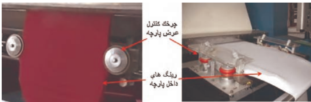
شکل ۳- ورودی پارچه برای ماشین کامپکت بغل بسته
