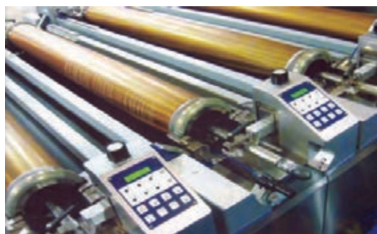
شکل ۲۲- تجهیزات تنظیم کامپیوتری شابلون‌ها در ماشین چاپ روتاری
