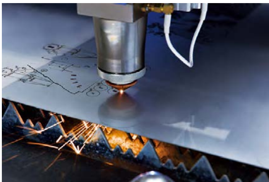
شکل ۱۹: برشکاری با پرتو لیزر
