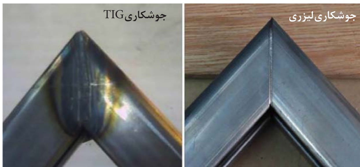
شکل ۲۳: مقایسه ابعاد منطقه متأثر از گرما (HAZ) در جوش لیزر و TIG
