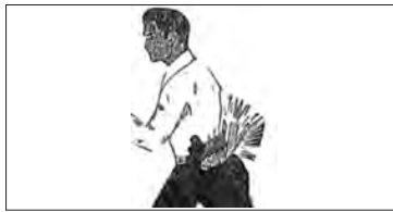
شکل ۶- خطر برخورد نوک تیز ابزار با بدن
