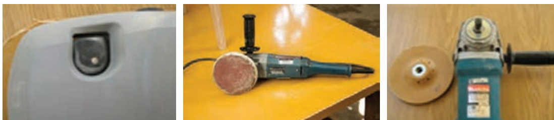
شکل ۱۷۴- اجزای سنباده دیسکی
