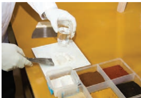
شکل ۷۰- اضافه کردن آب به بتونه
