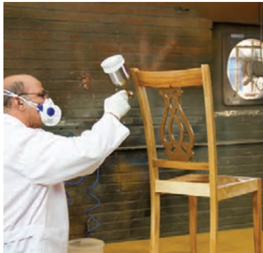
شکل ۴۳- زدن پلی استر با پیستوله
