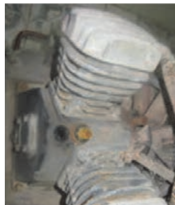
شکل ۱۸۷- مخزن روغن یک کمپرسور دو سیلندر
