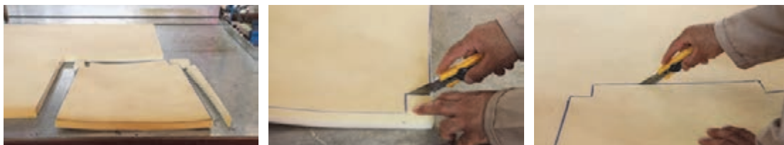
شکل ۴- برش کاری اسفنج کفی صندلی
