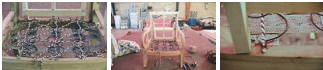
شکل ۳۲- بستن فنر با نخ فنربندی
