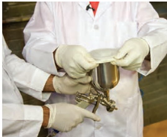
شکل ۱۸- استفاده از تنظیم برای صافی
