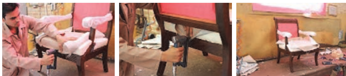
شکل ۳۶- کوبیدن پارچه کف مبل
