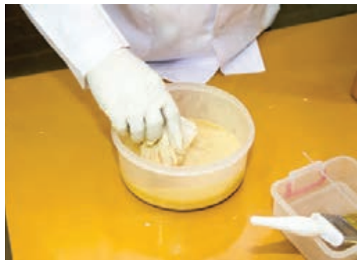
شکل ۱۴۵- استفاده از پارچه در لاک و الکل کاری
