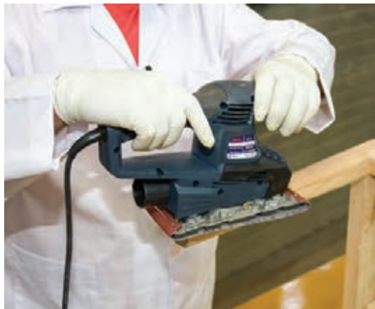
شکل ۴۶- سنباده کاری در جهت الیاف
