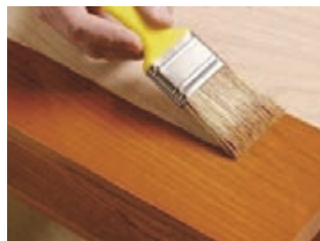
شکل ۵۷- روغن‌اندود کردن سطح کار
