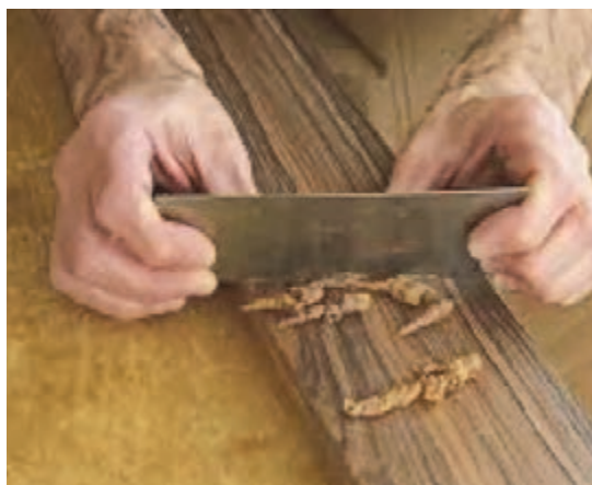
شکل ۵۵- لیسه کشی در جهت الیاف
