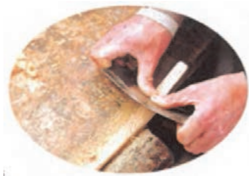
شکل ۵۶- استفاده صحیح از لیسسه
