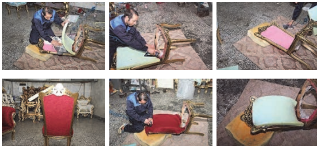
شکل ۳۷- مراحل رویه‌کوبی پشتی صندلی
