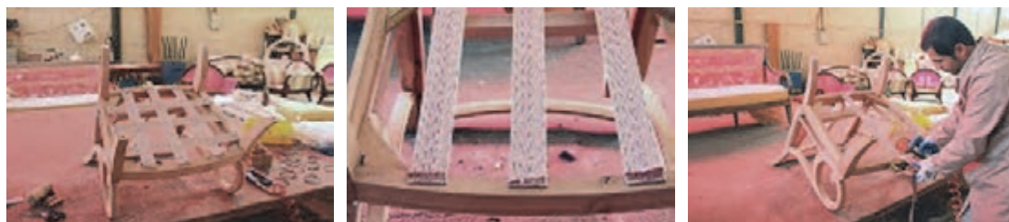
شکل ۳۰- مراحل تسمه کشی
