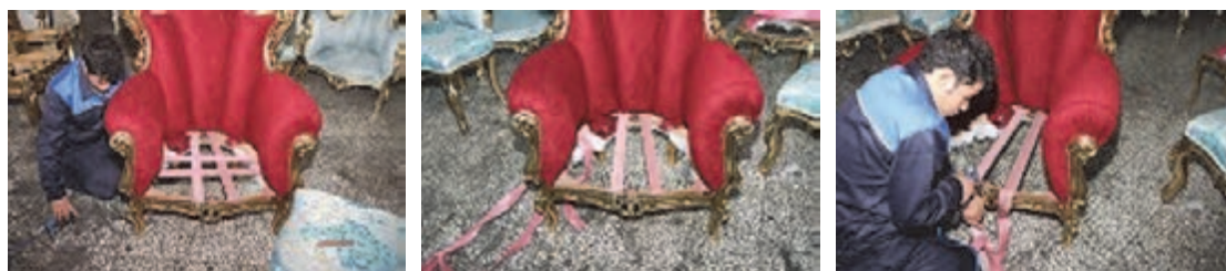
شکل ۲۹- مراحل تسمه کشی
