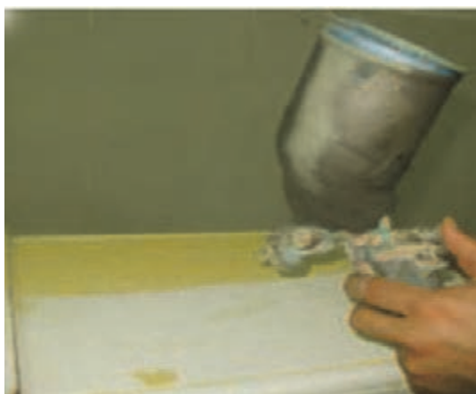
شکل ۲۹- پاشیدن رنگ نیترو سلولزی با پیستوله
