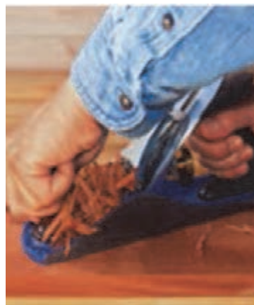
شکل ۱۲۶- رنده کاری سطح چوب
