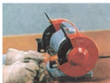
شکل ۱۳۲- سنگ تیغ تیزکنی شکل ۱۳۳- لبه تیغه را با آب خنک کنید شکل ۱۳۴- روغن یا نفت زدن روی سنگ
