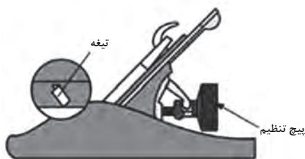
شکل ۶- پیچ تنظیم رنده
