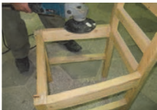
شکل ۷۲- پرداخت کاری قبل از بتونه
