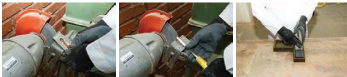
شکل ۳- تیز کردن تیغه رنده به صورت اصولی
