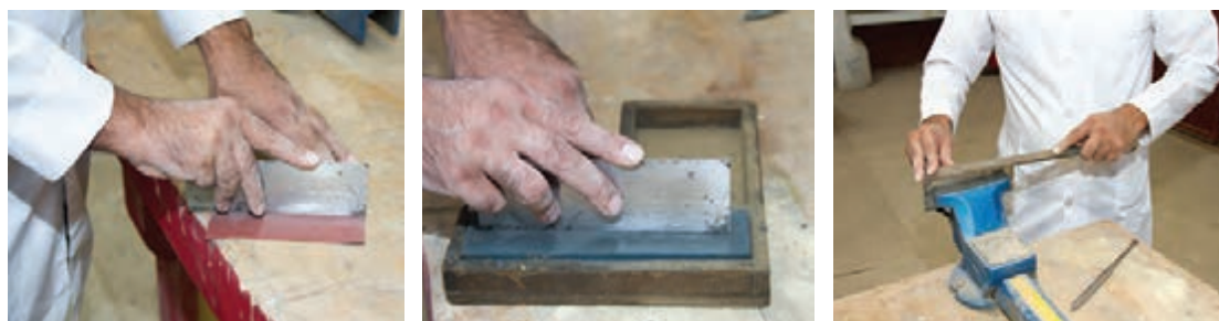
شکل ۱۱۸- سوهان کشیدن روی نر لیسسه شکل ۱۱۹- کشیدن لیسسه روی سنگ نفت شکل ۱۲۰- کشیدن لبه لیسسه به سنباده
