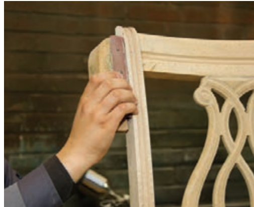
شکل ۹- سنباذه کاری به کمک تخته پوست
