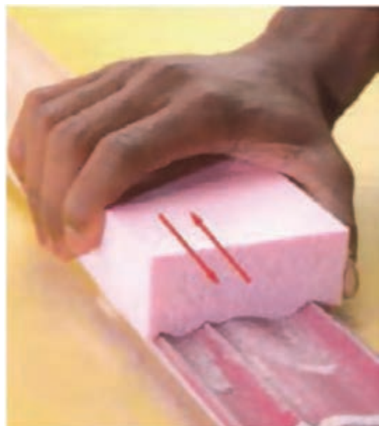
شکل ۱۰۸- تخته سنباده برای قطعه افزار خورده
