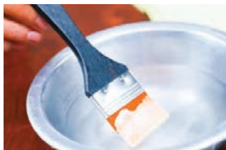
شکل ۳- شستن قلم‌مو با حلال به روش صحیح
