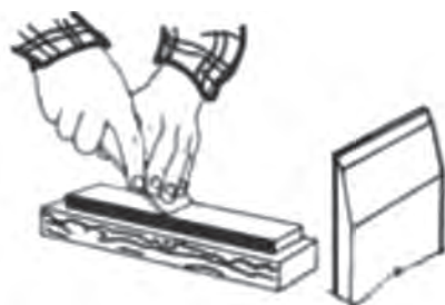
شکل ۲- تیز کردن مغار با سنگ نفت
