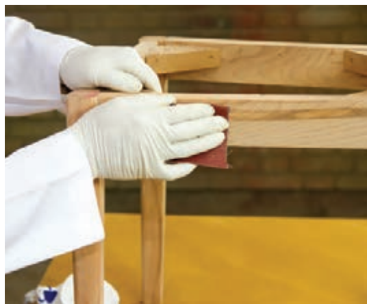
شکل ۱۲- سنباده کاری در جهت الیاف
