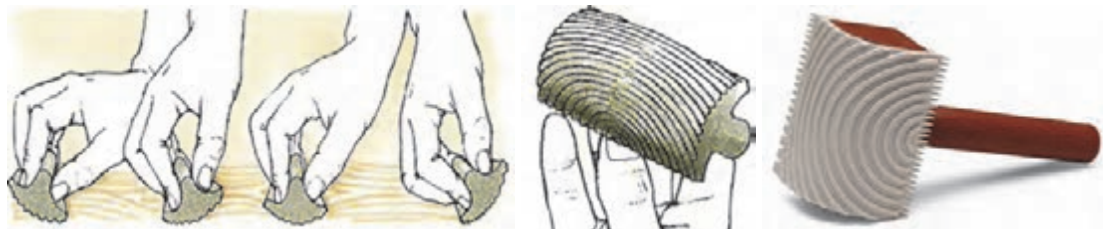
شکل ۱۶۰- روش صحیح استفاده از نقش‌انداز
