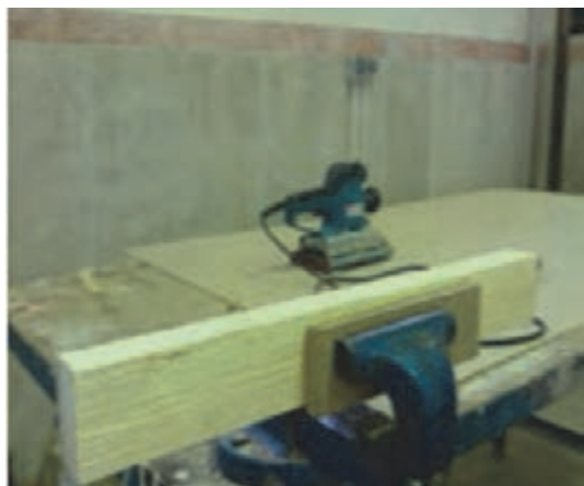
شکل ۴۵- بستن کار به گیره
