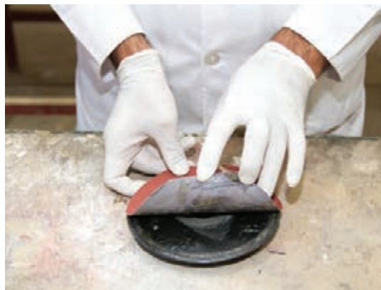
شکل ۱۷۶- چسب زدن به کاغذ سنباده
