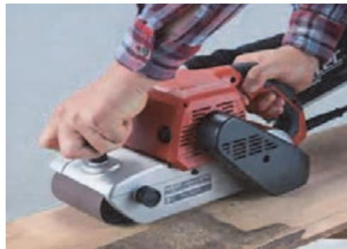
شکل ۴۸- سنباده کاری تخته‌های پهن
