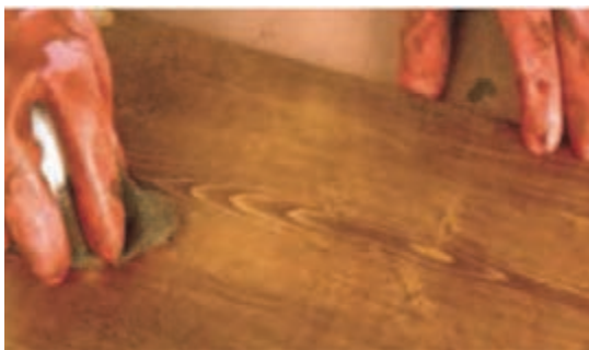
شکل ۱۴۴- زدن آستری هم رنگی با پارچه
