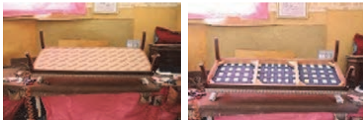
شکل ۳۹- پوشش کف مبلی با متقال
