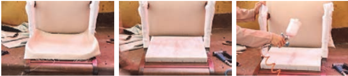
شکل ۳۸- مراحل رویه کوبی پشتی مبلی
