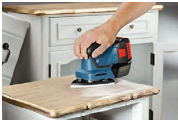
شکل ۳۳- فشار یکنواخت به سطح کار
