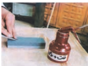
شکل ۱۳۲- سنگ تیغ تیزکنی شکل ۱۳۳- لبه تیغه را با آب خنک کنید شکل ۱۳۴- روغن یا نفت زدن روی سنگ
