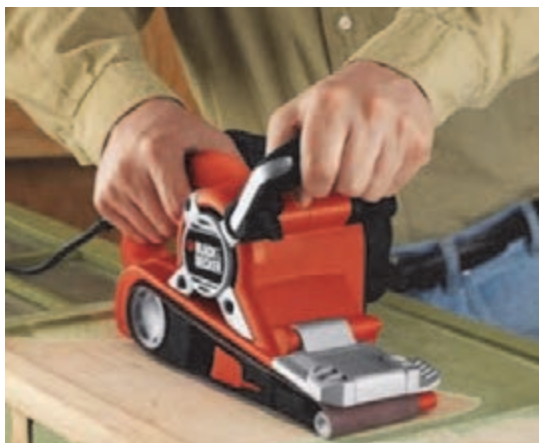
شکل ۵۳- روش کنترل و کاربرد صحیح دستگاه
