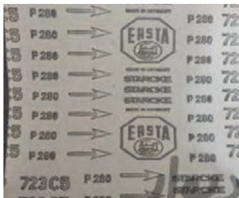
شکل ۵۱- به جهت فلش ورق سنباده توجه کنید.
