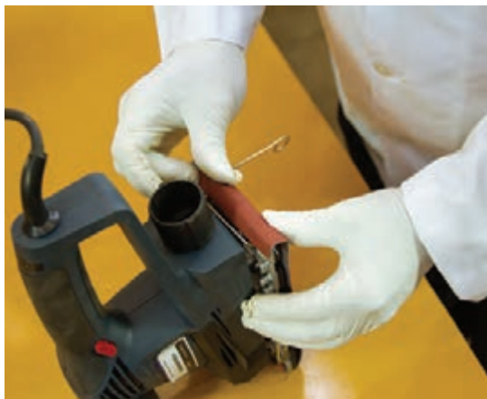
شکل ۴۴- روش جازدن سنباده
