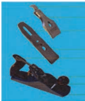
شکل ۱۲۸- رنده آهنی و تیغه های آن
