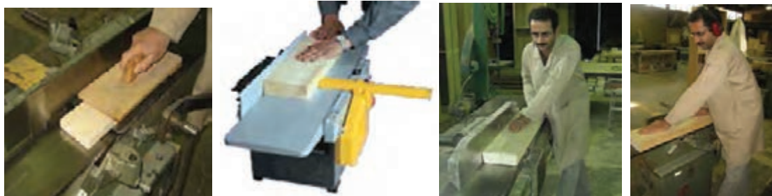
شکل ۲۹- نحوه رندیدن صحیح قطعه کار چوبی
