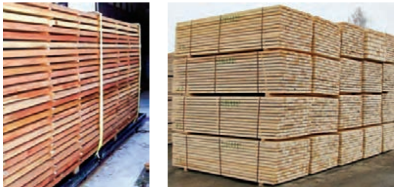
شکل ۱۲- چوب‌های با ضخامت یکنواخت در یک دسته قرار می‌گیرند.
