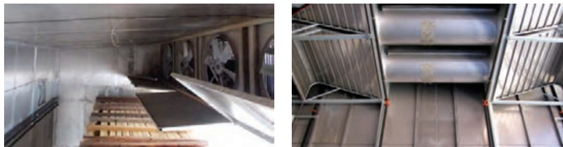
شکل ۴۸- مانع (سپر) در بالای کوره و روی چوب‌ها برای اطمینان یافتن از جریان هوا
