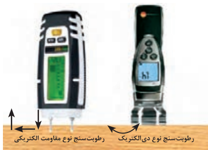
شکل ۸- روش کار رطوبت سنج های الکتریکی
