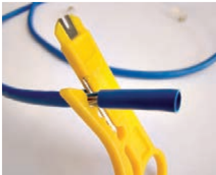
شکل ۲۵- لخت کردن سر کابل
