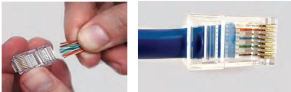
شکل ۲۸- قرار دادن سیم‌ها در سوکت
