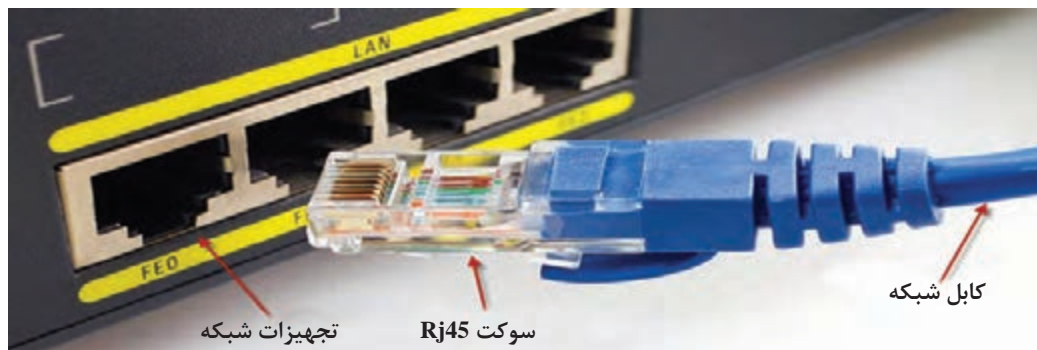
شکل ۶- اتصال سوکت Rj45 به تجهیزات شبکه
