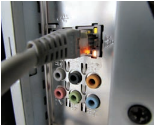
شکل ۴۳- چراغ‌های کارت شبکه
