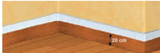
شکل ۵۲ - فاصله داکت یا ترانک از کف
