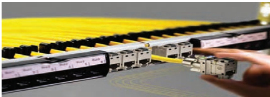
شکل ۵۴ - اتصال کابل به کیستون و قرار دادن در پیچ پنل
