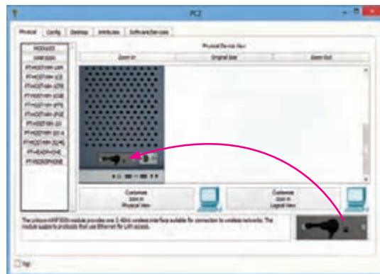
شکل ۱۹- قرار دادن کارت شبکه بی‌سیم
