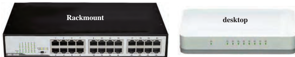
شکل ۴۹- سویچ Rackmount و desktop
