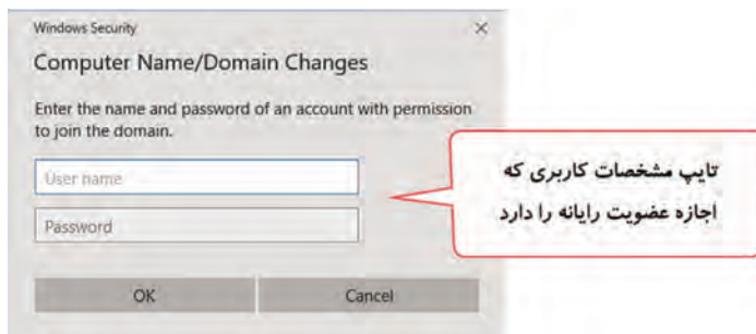
شکل ۲۸- کادر دریافت نام کاربری و گذرواژه کاربر مجاز به عضو کردن رایانه
