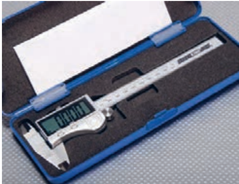
شکل ۲۷- نگهداری درست ابزار دقیق
