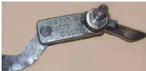
شکل ۱۵- پ (ب) لنگ چاقویی، پنجه رابط به سیلندر چاپ
