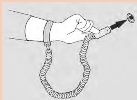
شکل ۲۷- الف) مچ‌بند مجهز به سیستم ارت
