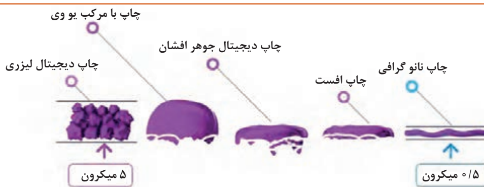
شکل ۷- وضعیت مرکب / جوهر بر سطح چاپ شده در روش‌های مختلف چاپ
