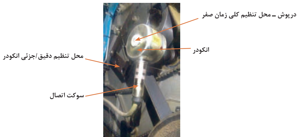
شکل ۲۵- ساختمان یک انکودر در ماشین چاپ
