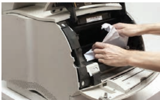
شکل ۱-۳۷- عیب‌یابی درگیر کردن کاغذ
