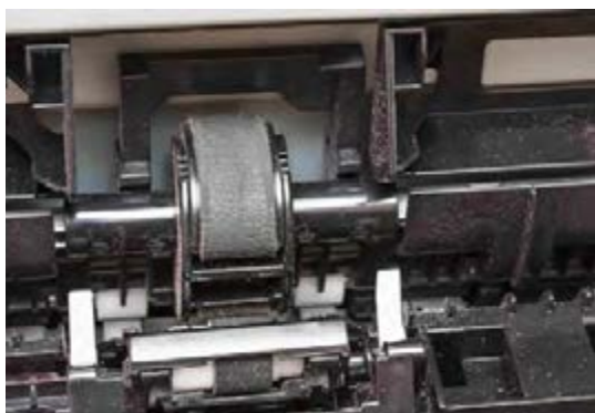
شکل ۳-۲۰- محل غلتک کاغذ کش در داخل پرینتر
