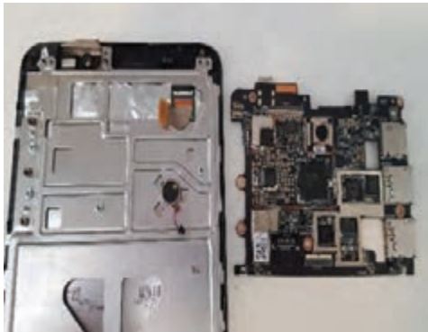
شکل ۵-۳۳- جدا کردن کامل برد از بدنه
