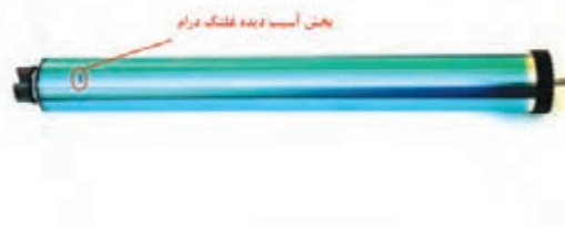
شکل ۴۵-۳- غلتک درام معیوب و اثر عیب درام بر روی چاپ
