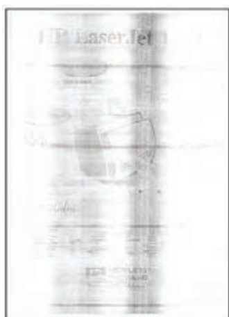
شکل ۴۴-۳ نمونه چاپ با کارتریج معیوب
