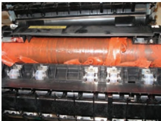
شکل ۳-۳۶- غلتک پرس معیوب
