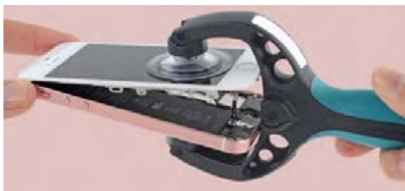
شکل ۵-۳۵- جدا کردن صفحه لمسی با ابزار وکیوم
