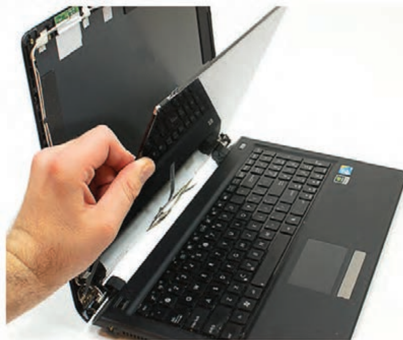
شکل ۵-۲۲- باز کردن نمایشگر لپ‌تاپ
