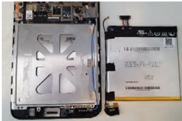
شکل ۳۰-۵ جدا کردن باتری از بدنه اصلی
