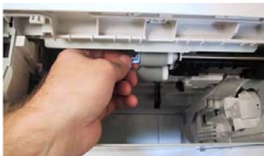
شکل ۲۲-۳ تعویض Separation Roller
