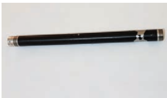
شکل ۳-۳۷- غلتک هات معیوب
