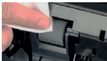
شکل ۶۱-۱. سرویس قطعات کششی
