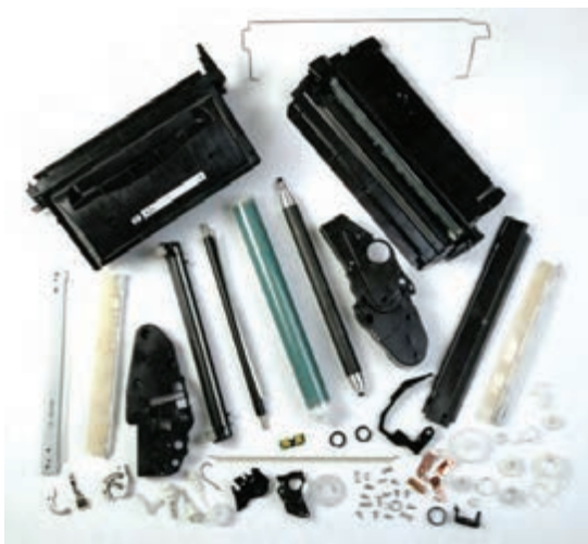
شکل ۲۸-۲ - قطعات تشکیل دهنده کارتریج All In One
