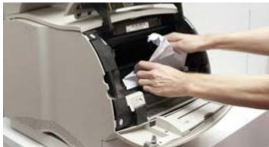
شکل ۳-۳۲- گیر کردن کاغذ
