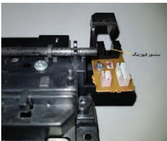
شکل ۳-۳۵- سنسور خروجی فیوزینگ یونیت
