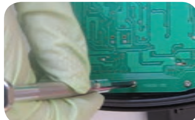
شکل ۱-۱۶- باز کردن پیچ‌های اتصال بدنه
