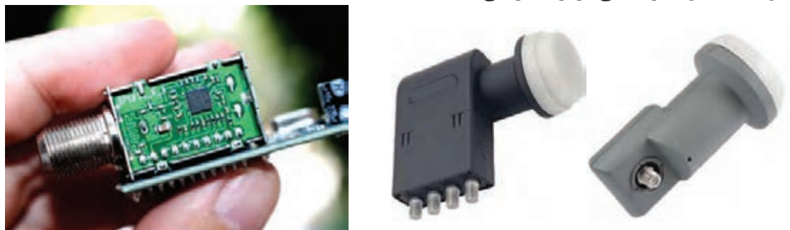
شکل ۴-۲۵ دو نوع LNB و مدار داخلی آن
