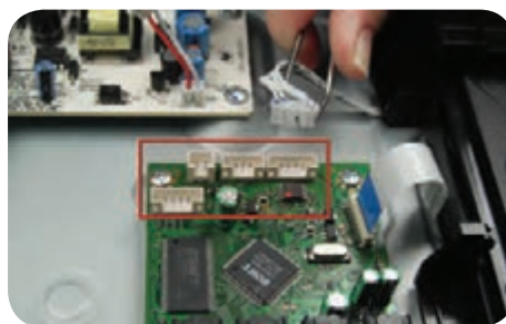
شکل ۱۹-۶ جدا کردن سوکت‌ها از برد پردازشگر
