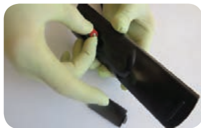
شکل ۷-۱- خارج کردن باتری
