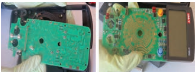
شکل ۱-۱۷- مولتی متر باز شده
