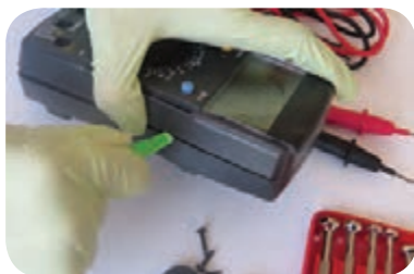
شکل ۱-۱۵- جدا کردن دو قسمت بدنه
