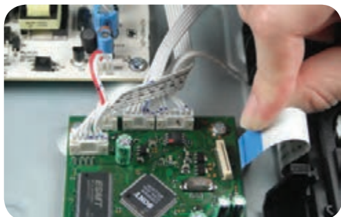
شکل ۱۸-۶ آزادسازی کابل پردازشگر
