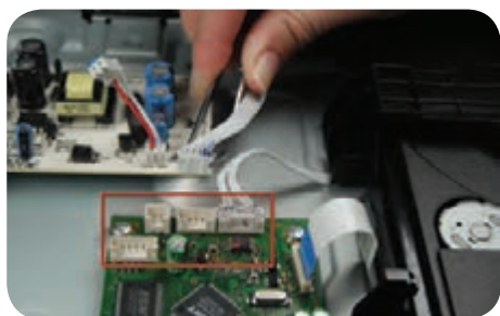
شکل ۲۰-۶ جدا شدن تمامی سوکت‌ها از برد
