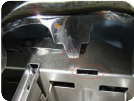
شکل ۶-۵۸ خار نر و ماده جهت اتصال
