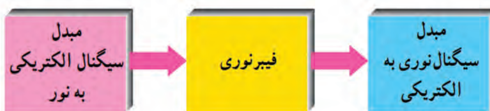
شکل ۴-۱۰- اساس یک سامانه فیبر نوری
