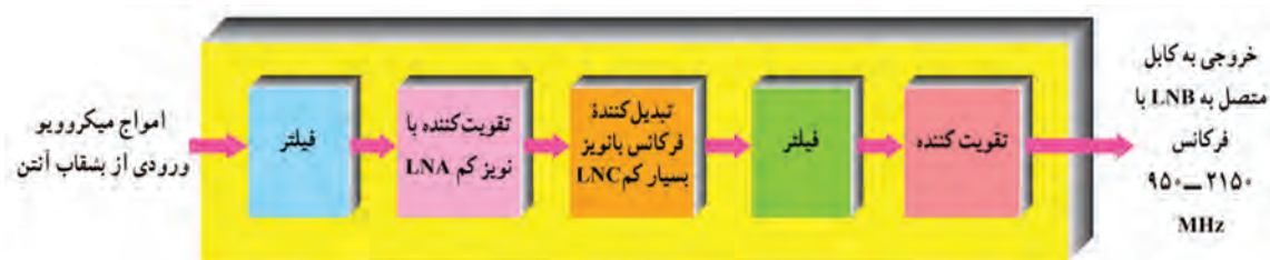
شکل ۴-۲۶ بلوک دیاگرام ساده LNB
