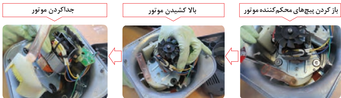
شکل ۲۶-۱- اینفوگرافی جدا کردن موتور
