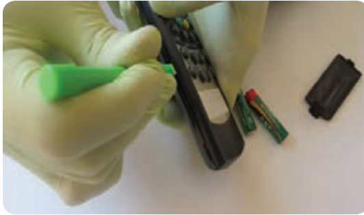
شکل ۸-۱ آزاد کردن خارهای قاب دستگاه ریموت کنترل
