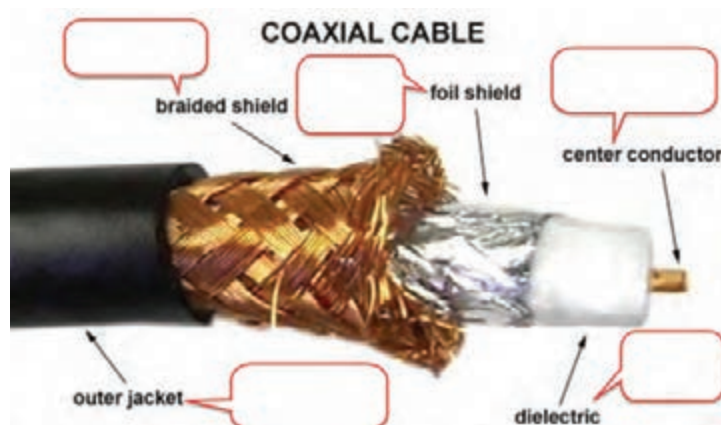
شکل ۴-۵- کابل کواکسیال و اجزای آن
