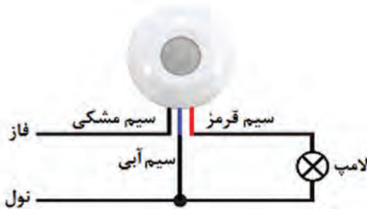
شکل ۲۸-۲ اتصال حسگر حرکتی به شبکه و لامپ
