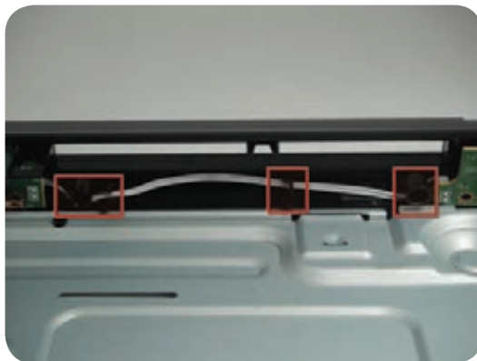
شکل ۶-۳۶ کابل اتصال پنل‌ها به هم
