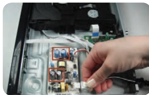
شکل ۶-۲۳ آزادکردن سوکت منبع تغذیه
