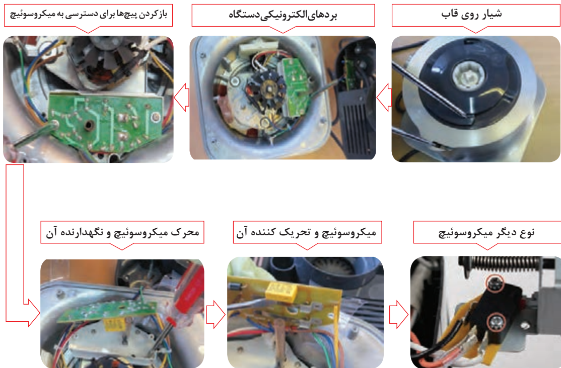
شکل ۲۵-۱- اینفوگرافی جدا کردن میکروسوییچ
