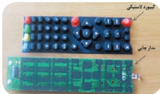
شکل ۴-۱. صفحه کلید و برد دستگاه ریموت کنترل
