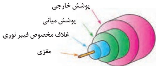
شکل ۴-۸- فیبر نوری و اجزای آن
