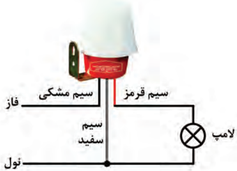
شکل ۲-۱۸- اتصال فتوسل به لامپ و شبکه
