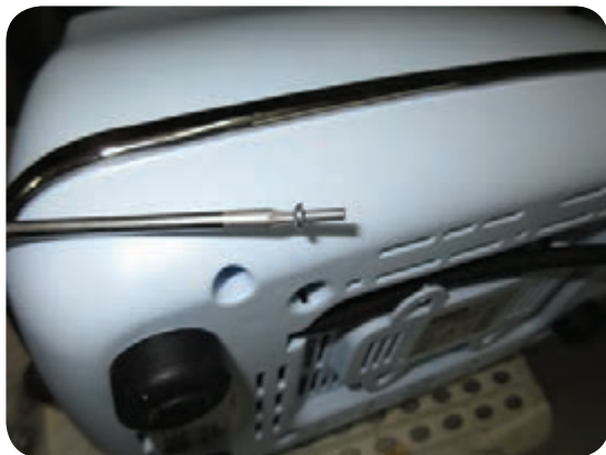
شکل ۶-۴۳ استفاده از ابزار خاص برای پیچ‌های ویژه
