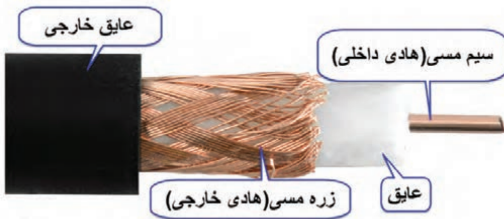
شکل ۴-۲- کابل کواکسیال و اجزای آن
