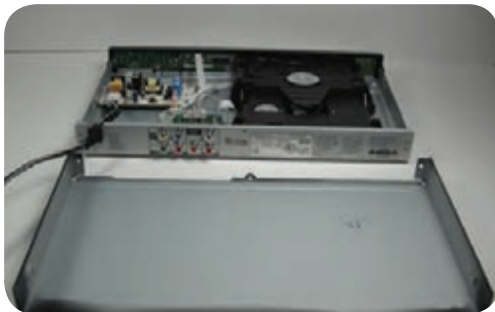
شکل ۶-۱۷ قاب پایینی جدا شده است
