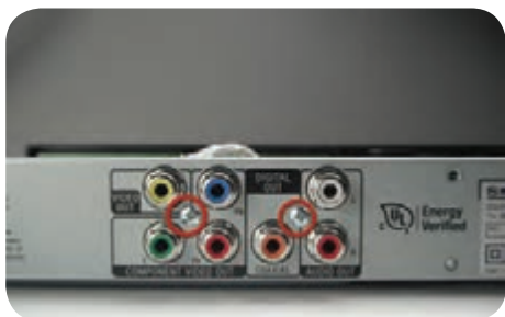
شکل ۲۲-۶ باز کردن پیچ‌نهایی برد پردازشگر
