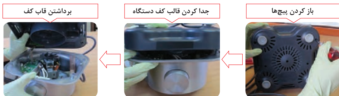
شکل ۲۲-۱- اینفوگرافی باز کردن کف دستگاه
