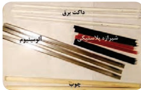
شکل ۲-۹- نمونه‌هایی از مواد مورد استفاده برای قاب تابلو
