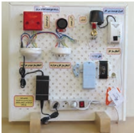
شکل ۳-۵۴- تابلوی اعلام حریق
