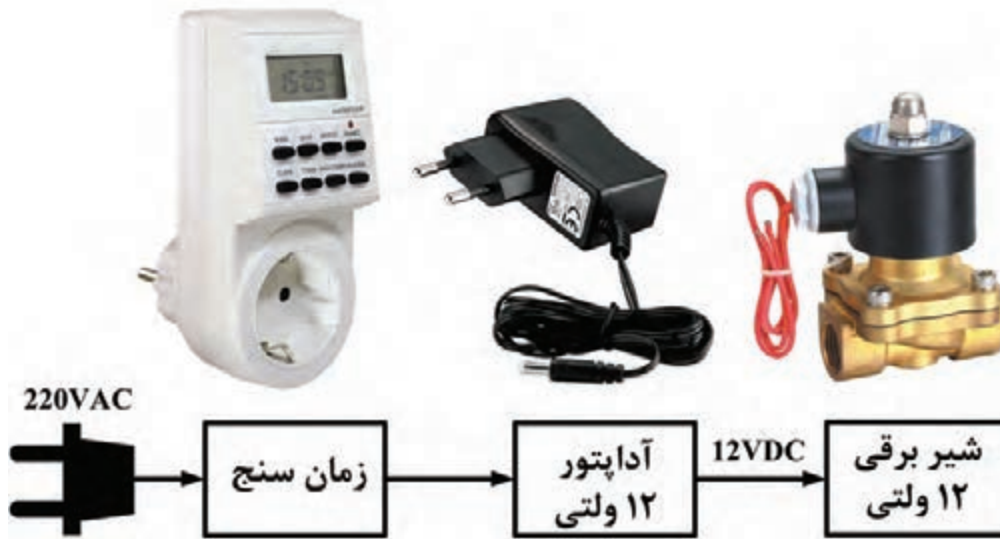
شکل ۲-۴۸- نصب شیر برقی ۱۲ ولت
