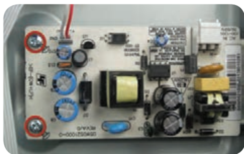
شکل ۶-۲۴ محل پیچ‌های محکم‌کننده برد منبع تغذیه
