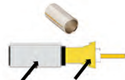
شکل ۲۲-۳- قراردادن حلقه روی کابل
