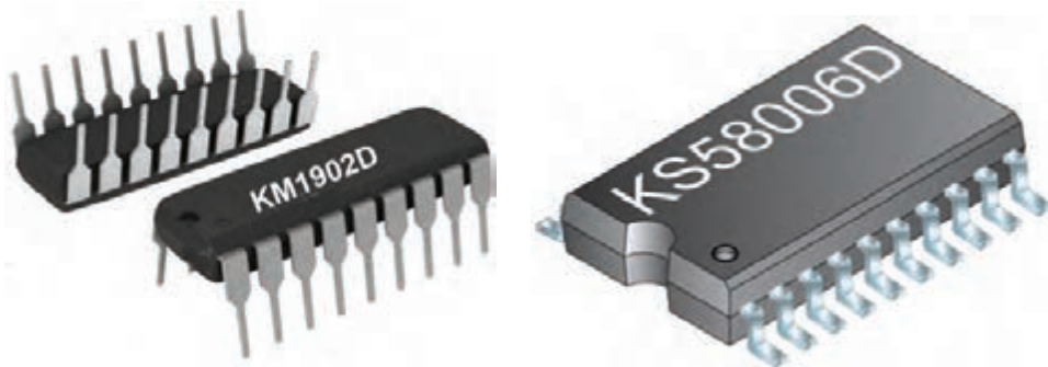
شکل ۵-۲۶- دو نوع آی‌سی شماره‌گیر
