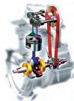
شکل ۳- میل سوپاپ بالای سیلندر
