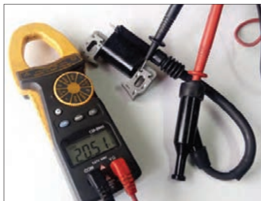
الف) مقاومت سیم پیچ ثانویه بین بدنه کویل و سر شمع حدوداً ۲۵/۵ کیلو اهم
