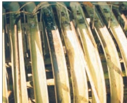
شکل ۶- ساییده شدن انگشتی‌ها به تسمه‌های راهنما
