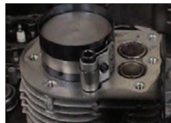
شکل ۳۲- جا زدن پیستون
