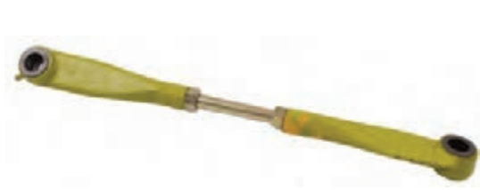
شکل ۶۲- میله رابط و یاتاقان‌های آن
