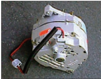
شکل ۱۸- آلترناتور مجهز به آفتامات الکترونیکی
