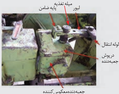
شکل ۹- قطعات بیرونی جعبه‌دنده معکوس کننده
