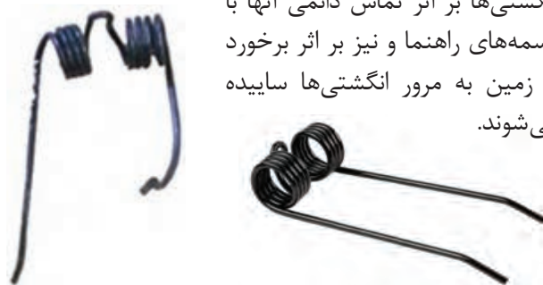
شکل ۴- تفاوت انگشتی سالم و انگشتی معیوب
