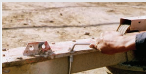
شکل ۲۰- باز کردن پیچ‌های سرپوش جعبه دنده
