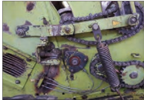
شکل ۳۷- فنر شناوری غلتک‌های بالایی
