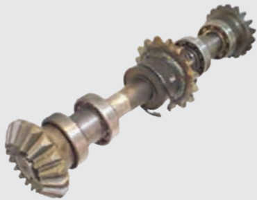
شکل ۳۵- محور افقی و اجزای آن
