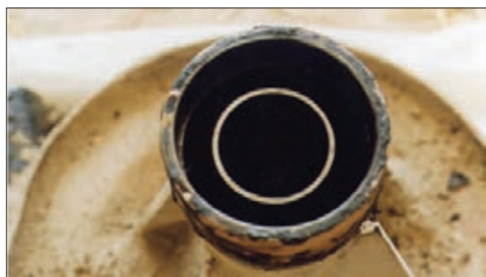
شکل ۴۳- ساییدگی جای بلبرینگ
