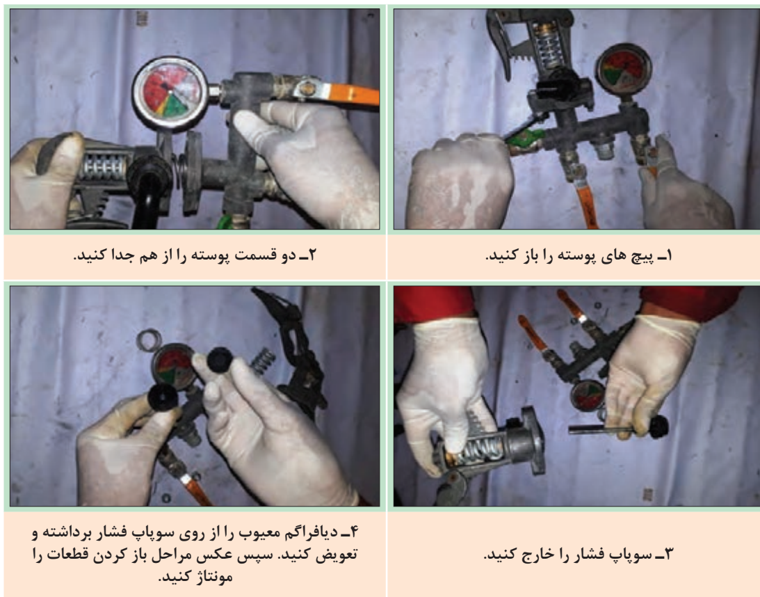
شکل ۵۲- تعویض دیافراگم رگولاتور مدل کمت
