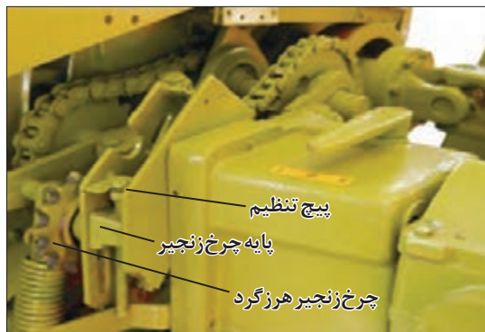
شکل ۷- زنجیر سفت کن با چرخ زنجیر واسطه
