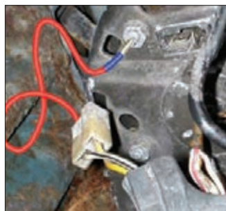
شکل ۲۷- آزمایش مدار لامپ شارژ
