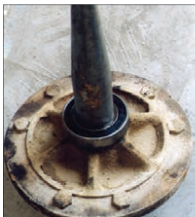
شکل ۴۹- محور استوانه و بلبرینگ
