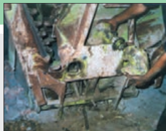
شکل ۲۴- برداشتن جعبه‌دنده دوقلو
