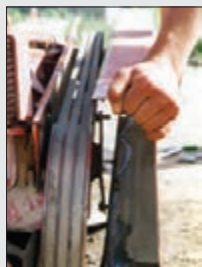
شکل ۸- برداشتن قاب تسمه‌ها
