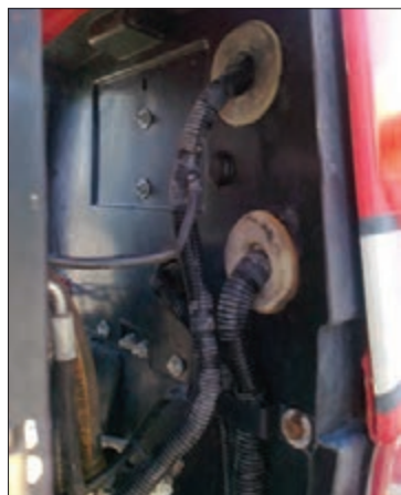
شکل ۳- ثابت کردن کلاف روی بدنه تراکتور
