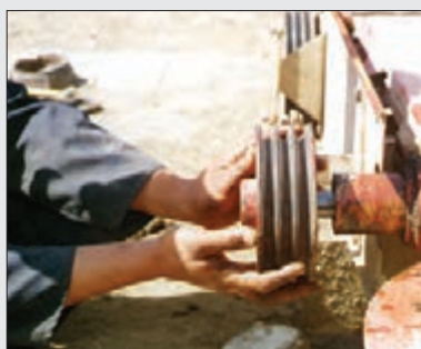
شکل ۱۱- برداشتن چرخ تسمه
