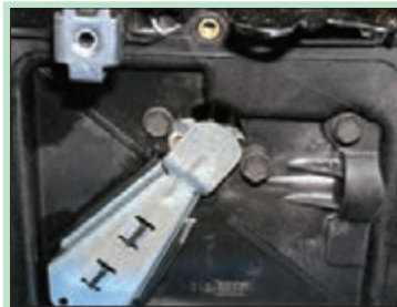
۶- پایه فیلتر هوا را با باز کردن پیچ‌های آن پیاده کنید.
