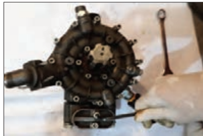
شکل ۴۸ - باز کردن درپوش سوپاپ‌ها
