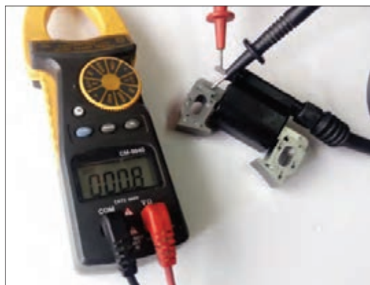
ب) مقاومت سیم پیچ اولیه (سیم متصل به سوئیچ) و بدنه کویل حدوداً ۰/۸ اهم
