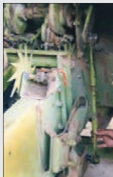
شکل ۶۵- برداشتن میله رابط
