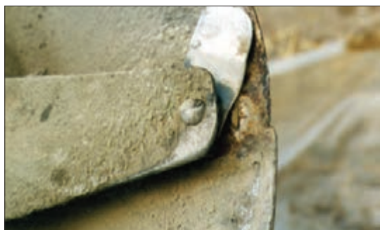
شکل ۴۲- خوردگی لبه استوانه
