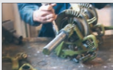
شکل ۷۶- پیاده کردن محور گره‌زن و اجزای آن
