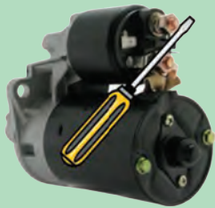
شکل ۴۳- اتصال کوتاه موتور استارت
