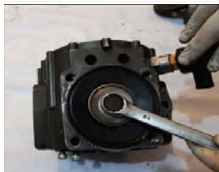
شکل ۴۶- باز کردن دیافراگم
