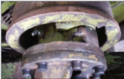
شکل ۴۸- پیچ‌های اتصال کلاچ به یوک چهارشاخه گاردان
