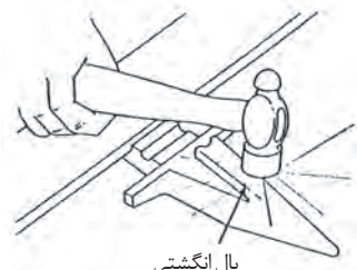
شکل ۶۶ - کم کردن فاصله بال با تیغه
