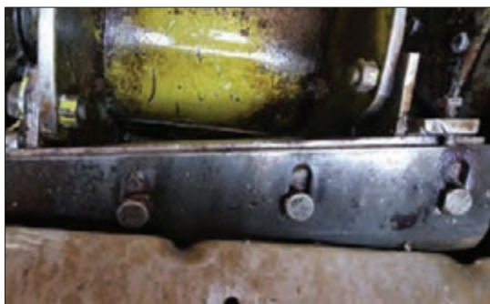
شکل ۴۴- پیچ و شیارهای رگلاژ تیغه متحرک
