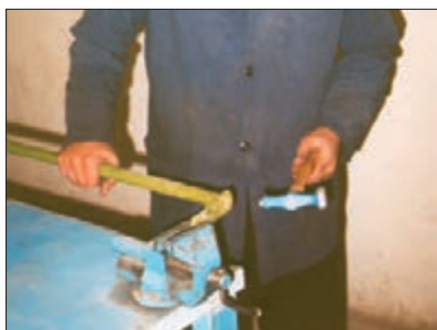
شکل ۱۵- صاف کردن پایه بلبرینگ
