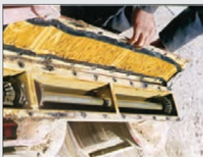
شکل ۲۱- برداشتن سرپوش جعبه دنده
