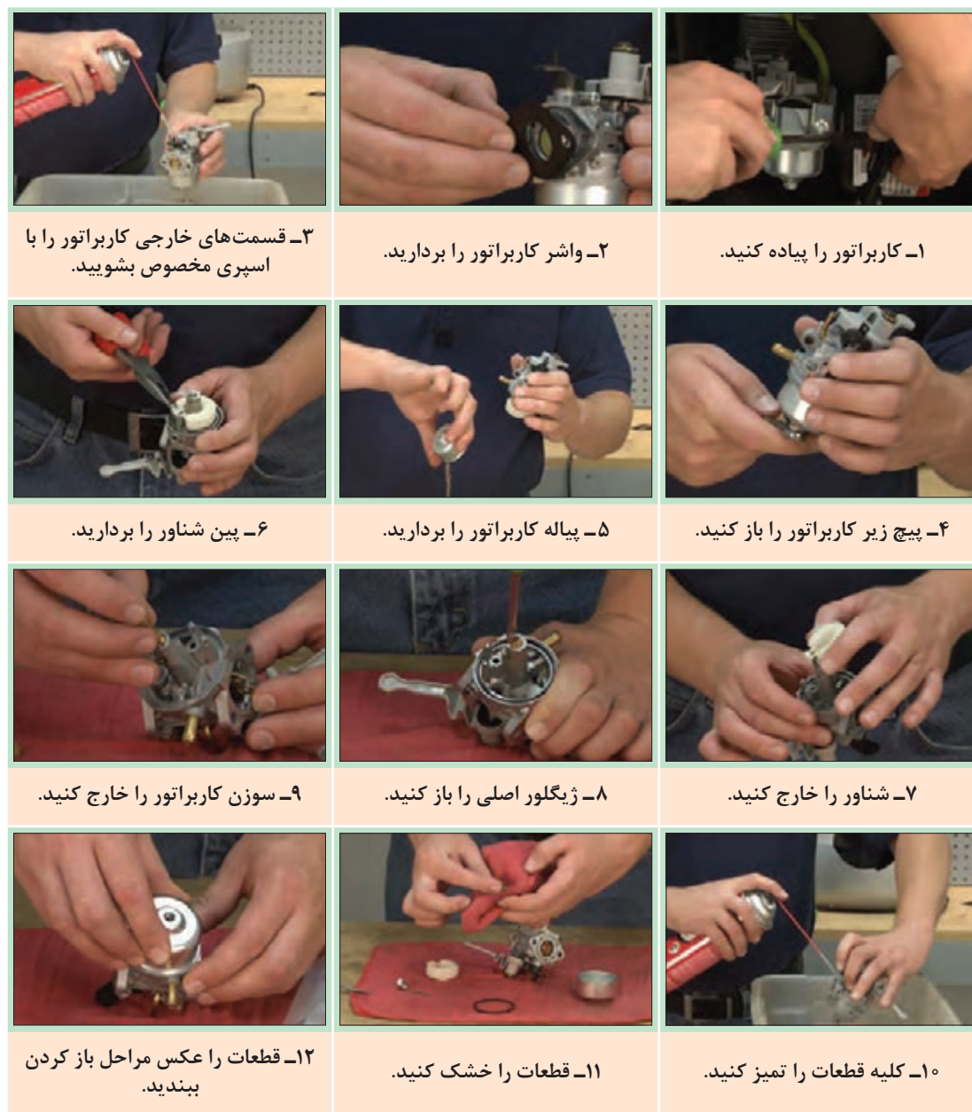
شکل ۲۵- باز کردن و تمیز کردن قطعات کاربراتور
