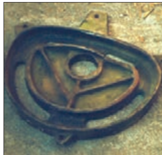
شکل ۱۸- صفحه بادامکی معیوب
