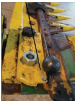
شکل ۶۳- تنظیم لقی سر شانه برش
