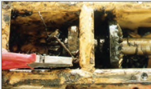
شکل ۲۶- باز کردن سیم مفتولی
