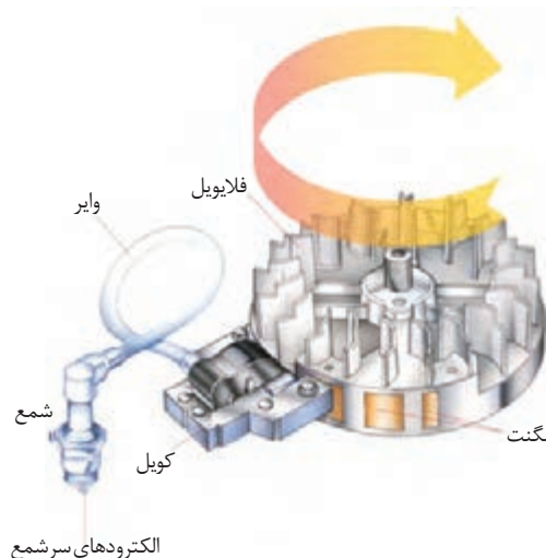
شکل ۷- طرز کار سیستم جرقه‌زنی
