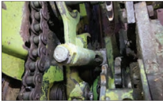
شکل ۴۳- اهرم و پیچ تنظیم تیغه ثابت
