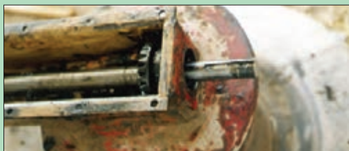
شکل ۲۸- خارج کردن محور افقی از محل درپوش
