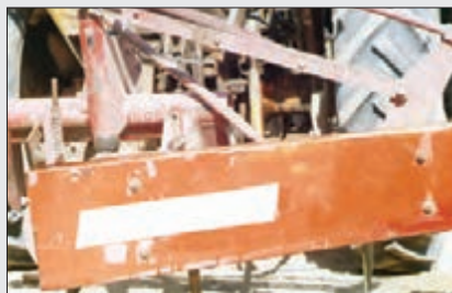
شکل ۷- باز کردن حفاظ تسمه‌ها
