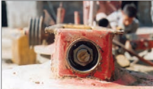
شکل ۲۵- پیچ محور افقی
