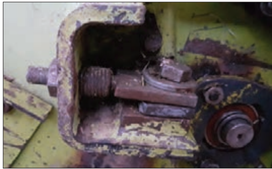
شکل ۴۲- پیچ تنظیم تیغه ثابت
