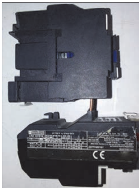
ج) اتصال بی‌متال زیر کنتاکتور
