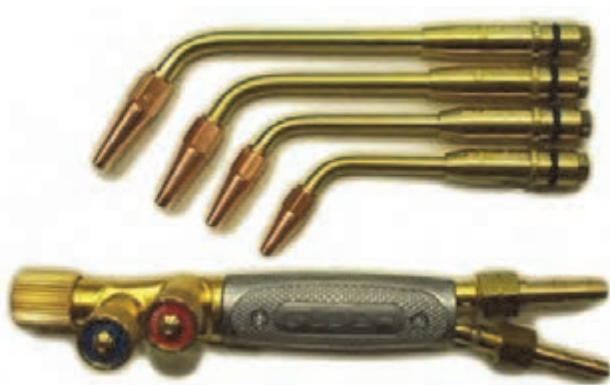
شکل ۶- مشعل جوشکاری و سرمشعل‌های آن
