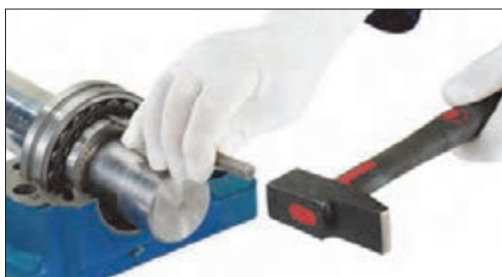
شکل ۶۲- جدا کردن بیرینگ از بوش مخروطی
