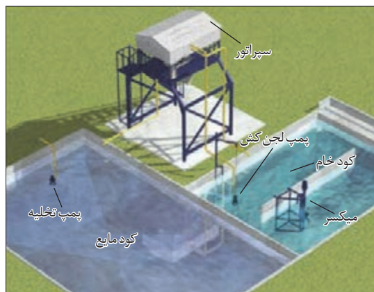
شکل ۳۰- تأسیسات مربوط به کود خشک کن
