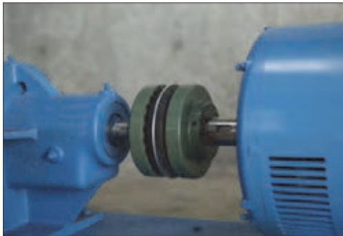
شکل ۷۱- اتصال موتور و دستگاه با کوپلینگ
