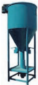
شکل ۷- مخلوط‌کن عمودی و نحوه عملکرد آن
