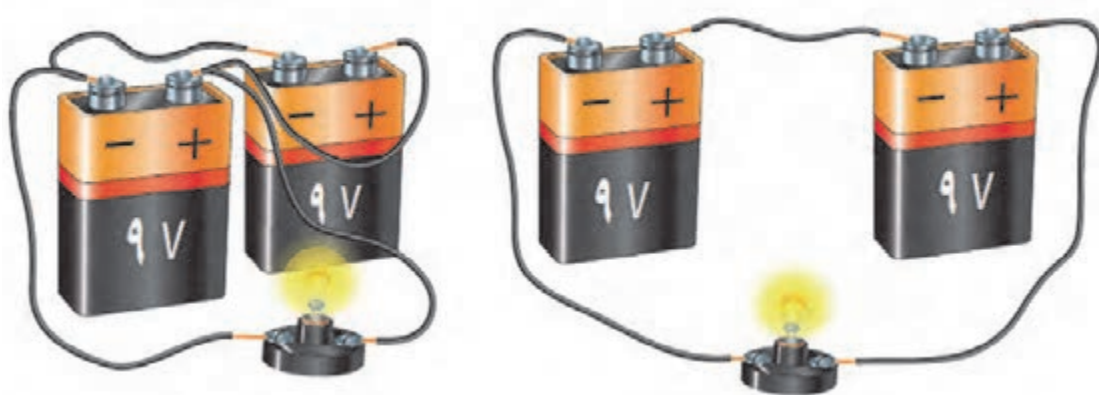
شکل ۱۵- اتصال سری و موازی پیل الکتریکی
