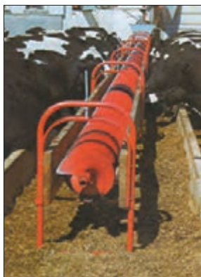
شکل ۲۲- توزیع خوراک به وسیله نقاله پیچی
