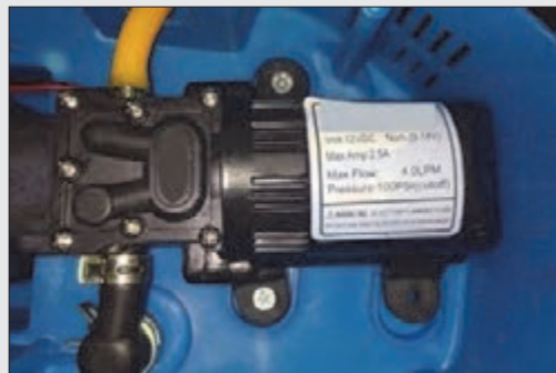
شکل ۳۲- اتصال پمپ و رعایت جهت حرکت سیال
