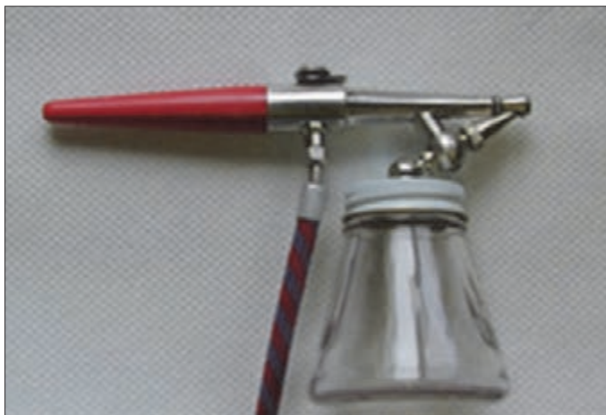
شکل ۶۲- ایربراش یا قلم رنگ پاش (Airbrush)
