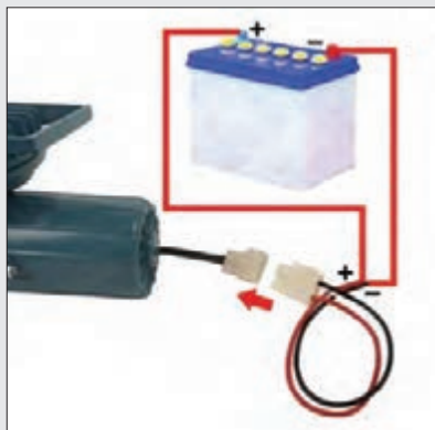
شکل ۴۲- اتصال پمپ با سوکت به باتری
