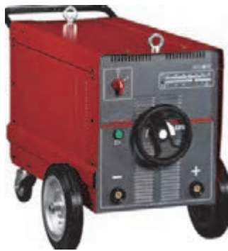
شکل ۹- ترانس با مکانیزم تغییر آمپر پیوسته
