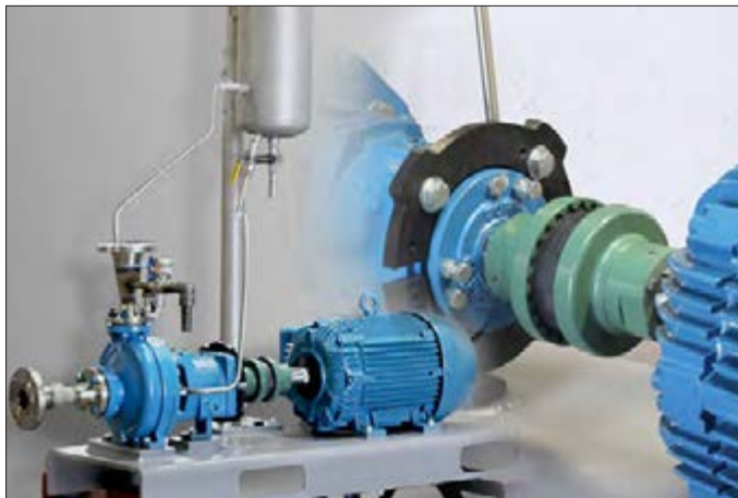
شکل ۸- انتقال قدرت مستقیم از موتور به دستگاه
