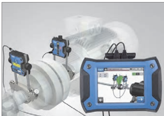
شکل ۷۸- هم‌راستا کردن محورها با دستگاه لیزر
