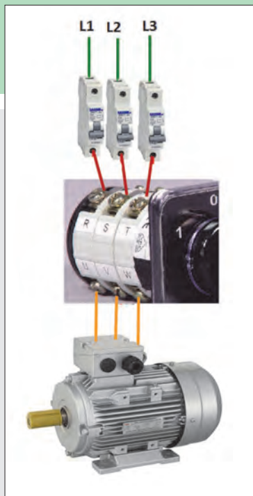
شکل ۲۷- نحوه کابل کشی و برق رسانی به یک موتور سه فاز آسنکرون با کلید زبانهای (۰-۱)
