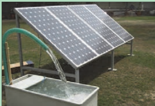
شکل ۳۸- کاربرد سامانه فتوولتاییک در پمپ چاه آب
