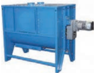
شکل ۸- مخلوط‌کن افقی و مارپیچ‌های آن
