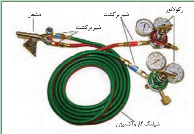
شکل ۱۸- محل نصب سوپاپ‌های یک طرفه (شیر برگشت)
