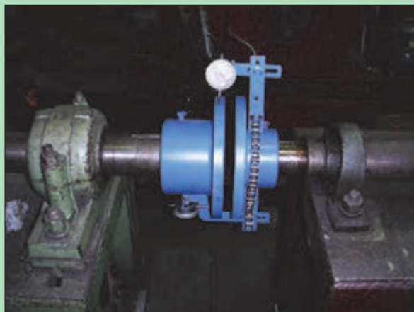
شکل ۷۷- هم‌راستا کردن محورها با ساعت اندازه‌گیری
