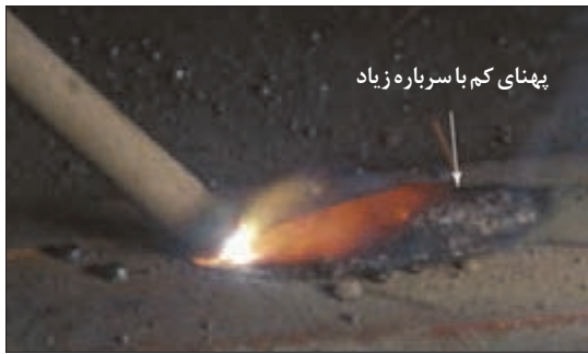
شکل ۳۰- جوشکاری با طول قوس بسیار کم
