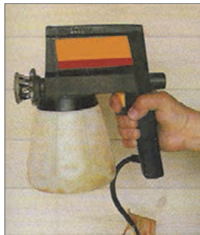
شکل ۶۱- پیستوله بدون کمک هوای فشرده (Airless)
