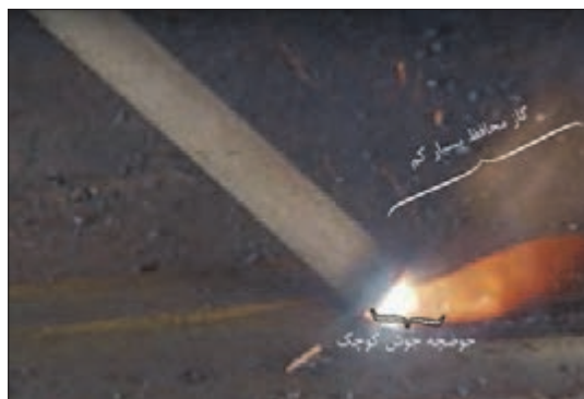
شکل ۲۶- جوشکاری با آمپر بسیار پایین
