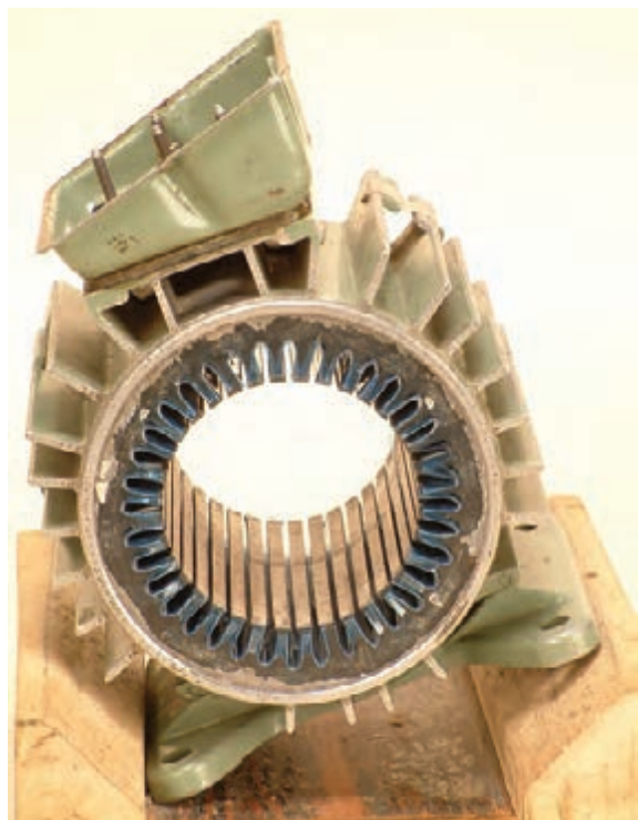
شکل ۱۳-۲- انتخاب شیار شروع و مسیر کلاف‌گذاری
