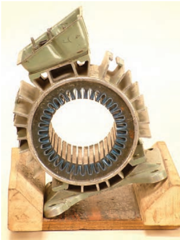
شکل ۲۹-۲-ب - انتخاب شیار شروع سیم بندی
