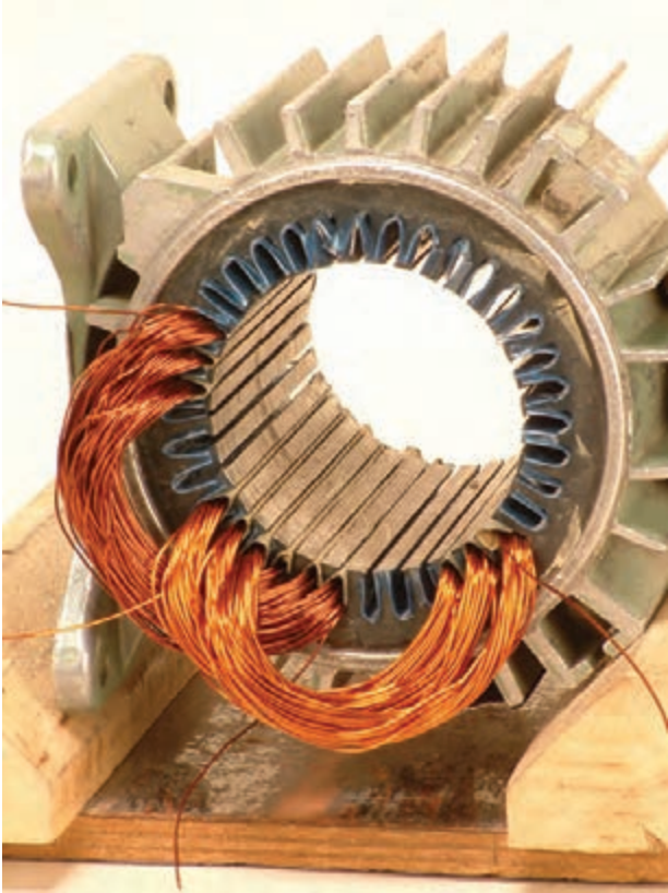
شکل ۲-۲۲- شروع گروه کلاف سوم از شیار شماره ۱۳
