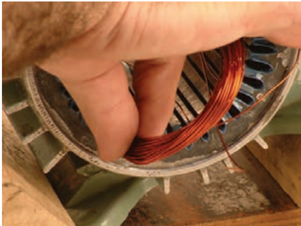
شکل ۱۵-۲- قراردادن بازوی شماره یک در شیار شماره ۱
