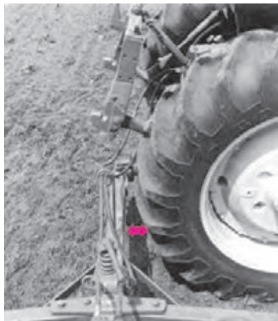
شکل ۳۵-۱- زاویه تند بین مالبند تراکتور و پی نورد
