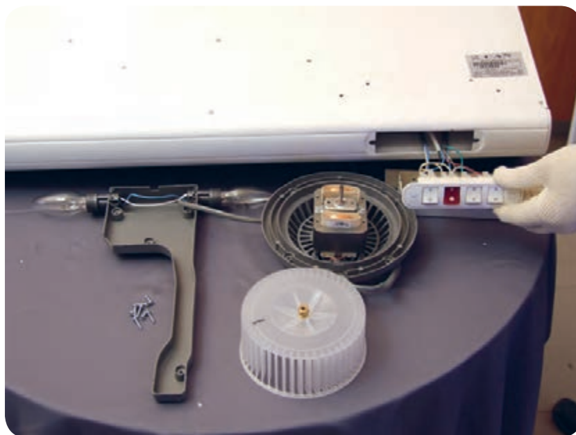
شکل ۱-۲۴ نقشه انفجاری هود آشپزخانه (دید از بغل)
