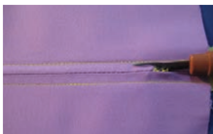
شکل ۸۷- زیپ دوطرفه (سمت راست) و شکافتن کوک بخیه (سمت چپ)
