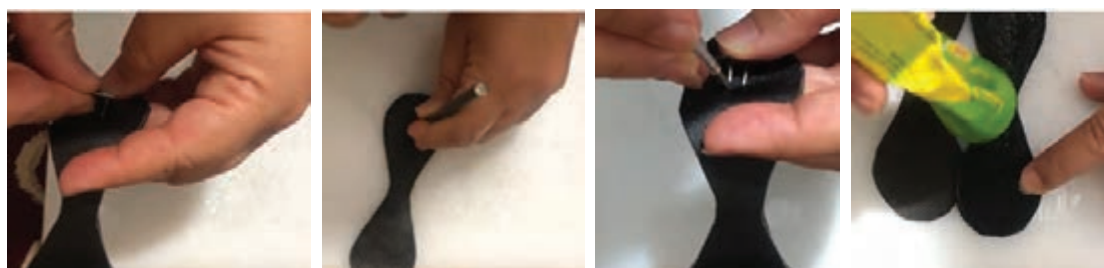
شکل ۷۴- چسب کاری الگوهای چرم (سمت راست) - تعیین و نصب محل نشان (وسط و چپ)
