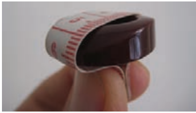
شکل ۱۰۰- نحوه به دست آوردن قطر دکمه
