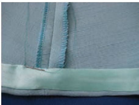
شکل ۷۷- دوخت نوار اریب به لبه دامن
