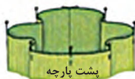
شکل ۲۱۱- روش دوخت کمر کش دار
