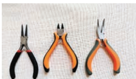
الف) دم‌باریک (ب) سیم‌چین (ج) انبردست سرکچ جواهرسازی دم‌گرد
