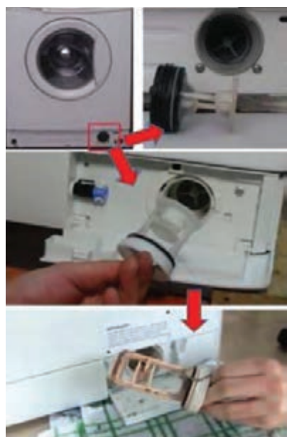
شکل ۳-۴- نحوه تمیز کردن فیلتر لباسشویی
