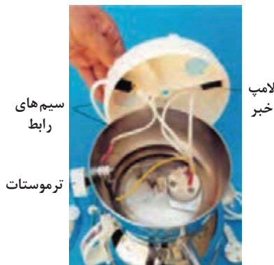
شکل ۱۷-۴ - اجزای داخلی سماور برقی
