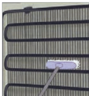
شکل ۵-۶ - تمیز کردن کندانسور یخچال
