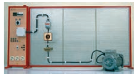
شکل ۱۳۷ - نمای قطعات نصب شده به همراه کابل و موتور متصل شده
