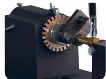
نحوه چند وجهی کردن قطعه با دستگاه تقسیم مستقیم
