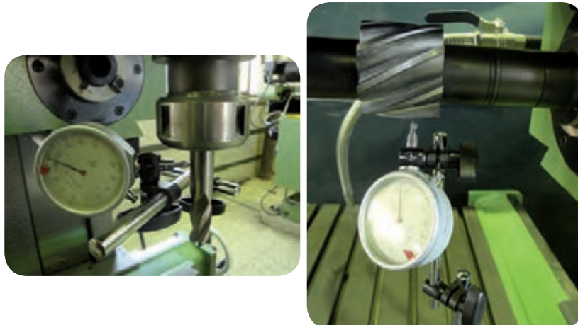
کنترل دور بودن تیغه فرز از لنگی با ساعت اندازه‌گیری
