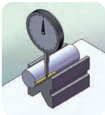
کنترل شیار از نظر طولی
