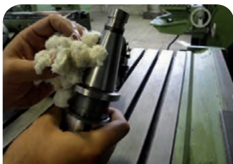
تمیز کردن دنباله میله فرزگیر
