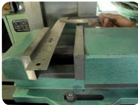
تنظیم فک‌های گیره با استفاده از گونیا
