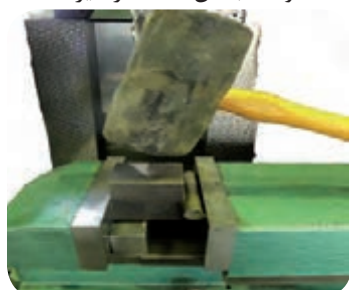
اطمینان از چسبیدن قطعه به سطح لوک زیرین
