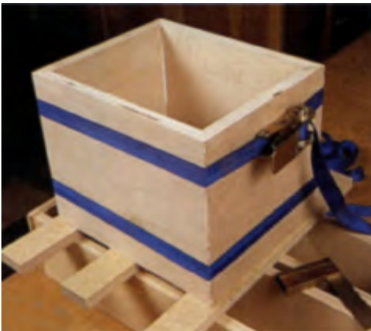
شکل ۱۴۸- از گیره‌ی تسمه‌ای می‌توان برای پسباندن بدنه‌های صندوق مکعبی نیز استفاده کرد. با توجه به ارتفاع آن، می‌توان ۲ تسمه یا بیشتر به‌کار برد.
