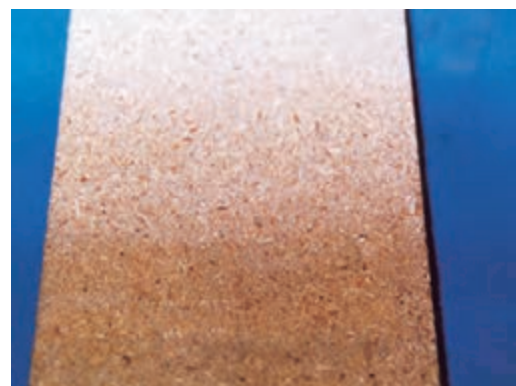
شکل ۴-۲- سطوح تخته فرده چوب، به دلیل فلل و فرج بسیار و شکل ظاهری بد، باید به صورت سرتاسری بتونه شود.
