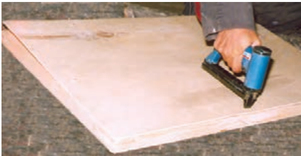
شکل ۶-۲۱- ثابت کردن روکش روی صفحه‌ی کار توسط منگنه.
