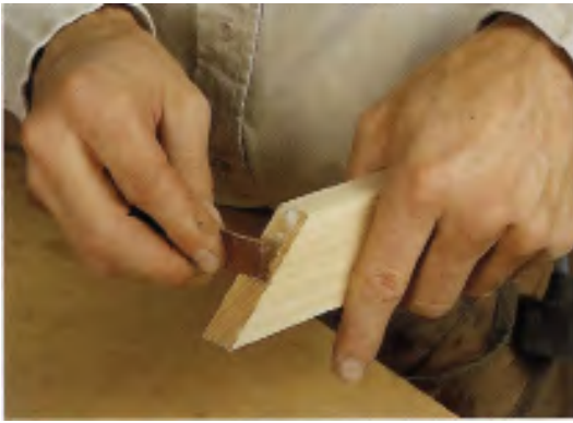
شکل ۱۴۶- برای پسباندن دو سر چوب به یکدیگر، باید چسب‌زنی را یکبار انجام داد، و پس از نمو شدن چسب هنگام بستن قطعات، مجدداً به سر چوب چسب زد.
