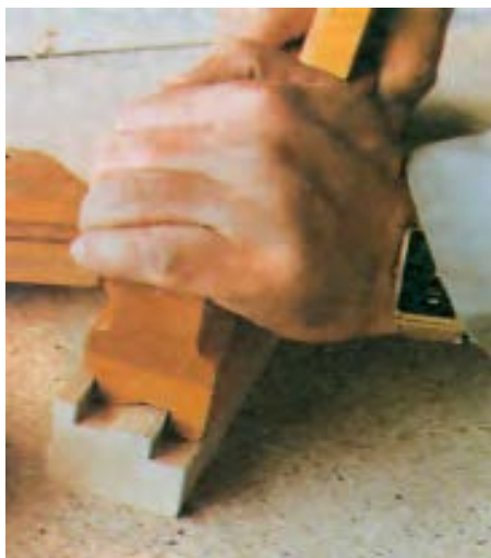
شکل ۶-۱- رنده دستی افزار (پروفیلی)، برای تهیه زهوار تزئینی.
