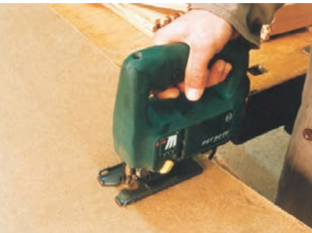
شکل ۶۱-۹- برش کف جعبه با اره عمودبُر برقی - دستی.
