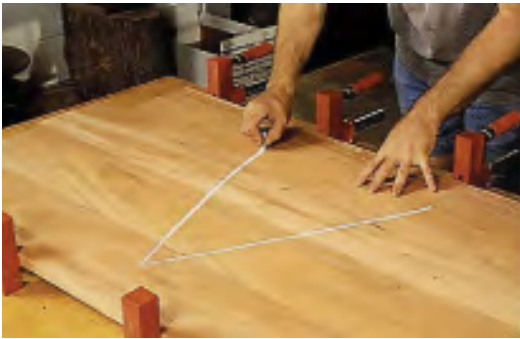
شکل ۱۴۷- تخته‌های درز شده را باید کنار هم روی تنگ‌ها قرار داد و علامت مثلث (Δ) را روی آن ترسیم کرد؛ سپس باید آنها را چسب زد، در جای خود قرار داد و تنگ‌ها را محکم نمود.
