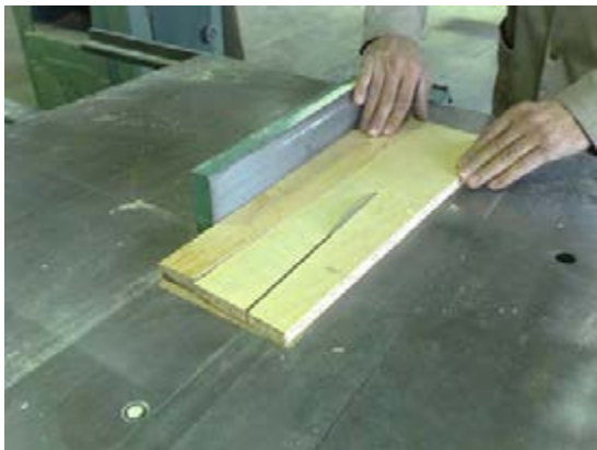
شکل ۱۲-۱۳- برش پایه ها با اره گرد مخصوص MDF.
