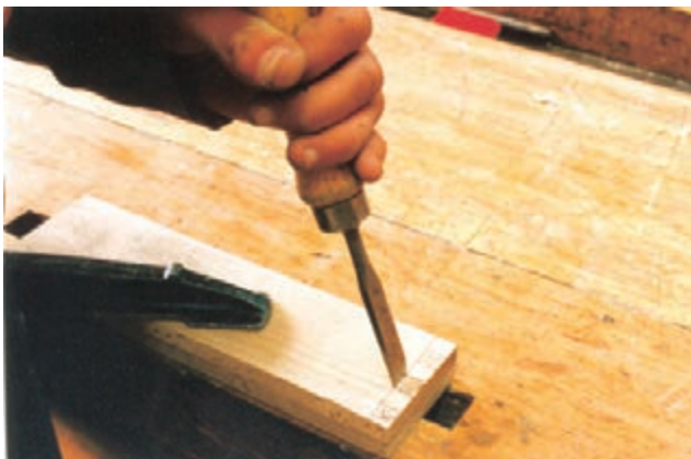
شکل ۹-۶۶- فالی کردن ممل فاق و زبانه با مغار و پککش چوبی.
