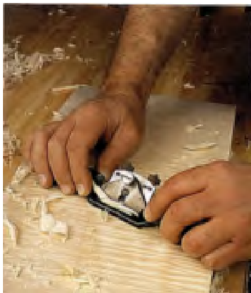
شکل ۲-۳۶. با رنده بال کبوتری نیز، می‌توان سطوح چوبی را پرداخت کرد.
