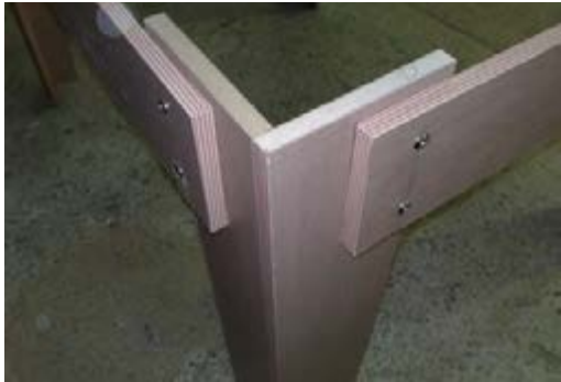
شکل ۱۲-۱۶- اتصال پایه به قید توسط پیچ فیکس.
