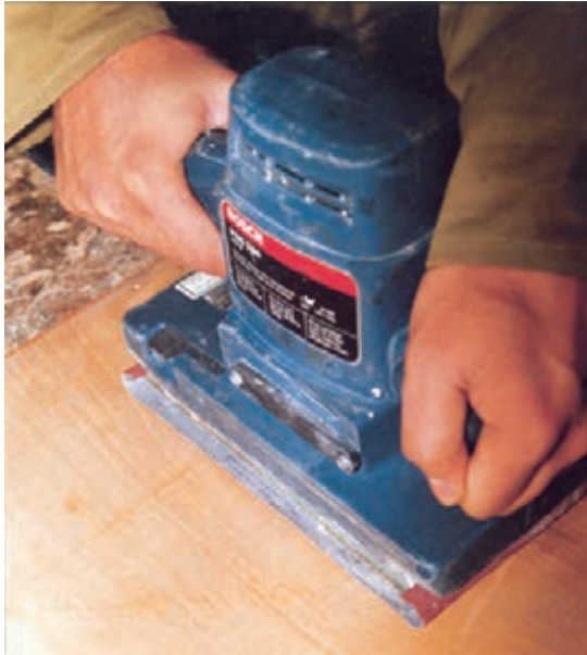
شکل ۷-۱۱. سنباده کاری در جهت الیاف.
