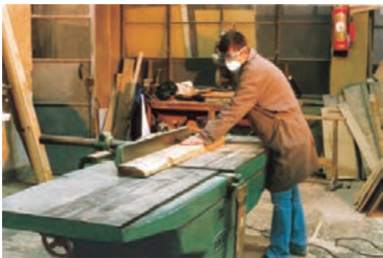
شکل ۹-۹- مقدار باز بودن زیاد گونیا، فطرآفرین است.
