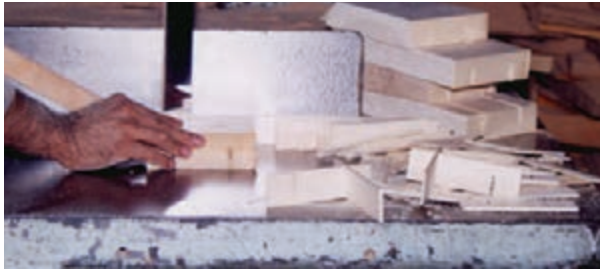
شکل ۱۱-۳۱- تولید شبکه‌های داخل در.
