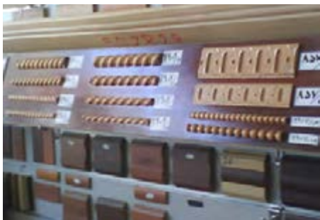
شکل ۴-۱۰- نمونه‌هایی از زهوارهای تزئینی؛ مورد استفاده در نر صفحات، قاب‌ها، روکوب دور کارهای چوبی و...
