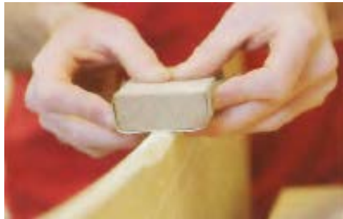
شکل ۳-۲۱. طریقه‌ی سنباده‌کاری نر قطعات با دو دست.
