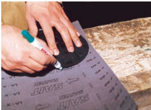
شکل ۷-۳۵- ترسیم گردی دیسک روی سنباده.
