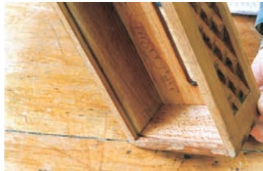
شکل ۹-۶۷- کنشکاف داخل بدنه‌های یک جعبه دستمال کاغذی.
