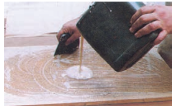
شکل ۴-۶- پفش کردن چسب به وسیله‌ی شانه‌ی چسب‌زنی.
