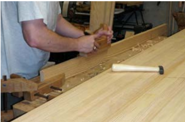
شکل ۲-۲۴- نحوه‌ی هدایت رنده برقی - دستی برای پرداخت قطعات طویل و بزرگ.
