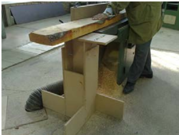
شکل ۹-۱۴- کاربرد میز کمکی برای ماشین کفرند.
