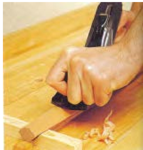
شکل ۲۷- نمونه‌ی پرداخت قید شش‌ضلعی با رنده پرداخت.
