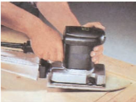
شکل ۷-۴۷- سنباده کاری گوشه‌های تیز داخلی با دستگاه سنباده کف مثلثی.
