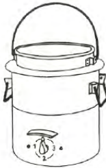
شکل ۱-۳. ظرف سریشم الکتریکی با جای آب از ورق مس.
