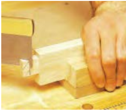
شکل ۹۹- به اندازه (سازدن زبانه با اره‌ی ظریف‌بُر (پشت‌دار).
