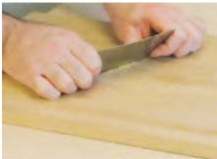
شکل ۲-۱۳- جهت حرکت لیسه، هنگام پُرزگیری.
