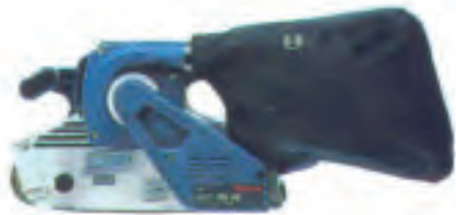
شکل ۷-۷- دستگاه سنباده‌ی نواری با کیسه گرد سنباده.
