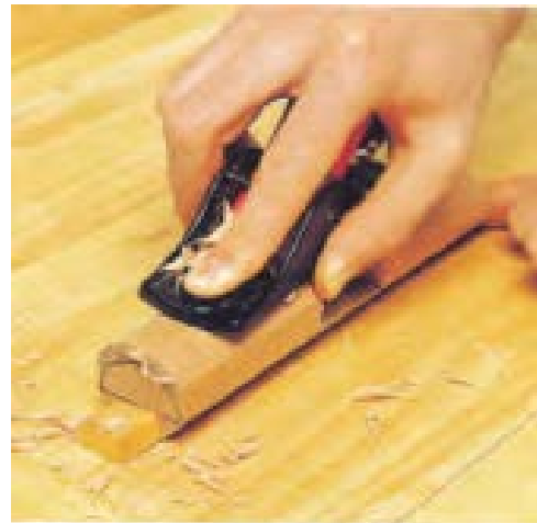
شکل ۲۶- نمونه‌ی پرداخت قطعه‌ای با مقطع نیمگرد.
