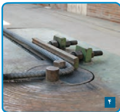
شکل ۳-۶۴- خم کردن میلگرد
