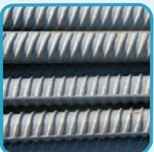
شکل ۱۷-۱- میلگرد با رویه آجدار
