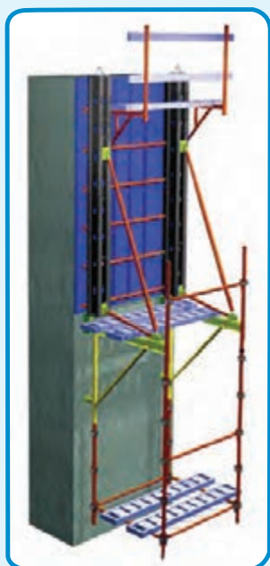
شکل ۲۰-۳- قالب رونده (لغزنده)
