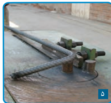
شکل ۳-۶۴- خم کردن میلگرد
