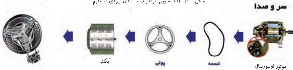
شکل ۱-۱۴۵-الباسشویی اتوماتیک با انتقال نیروی غیرمستقیم
