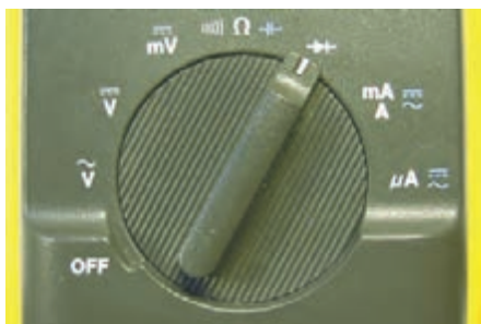
شکل ۱۷-۱- وضعیت آزمایش دیود با مولتی‌متر دیجیتالی
