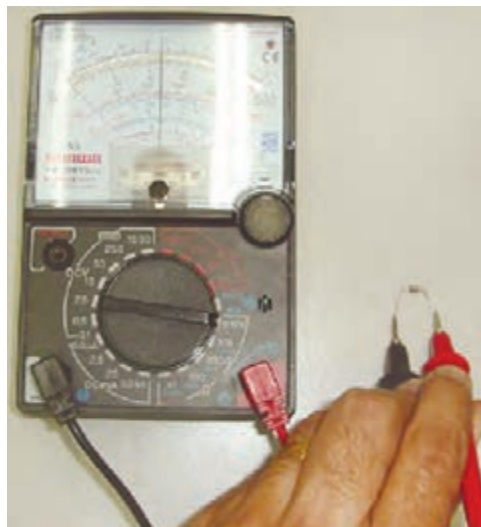
شکل ۱۶-۱- تست دیود با اهم‌متر عقربه‌ای
