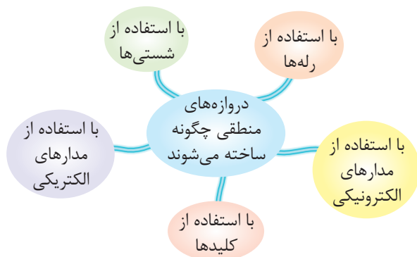
شکل ۱۷-۴- وسایل مورد استفاده در ساخت دروازه‌های منطقی
