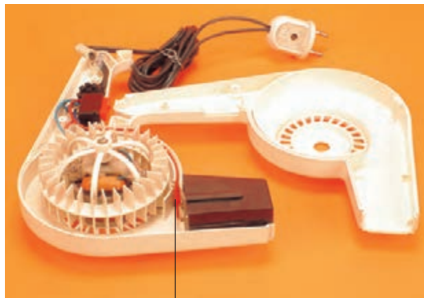
شیار مخصوص قرارگرفتن سیم‌های رابط موتور و المنت
