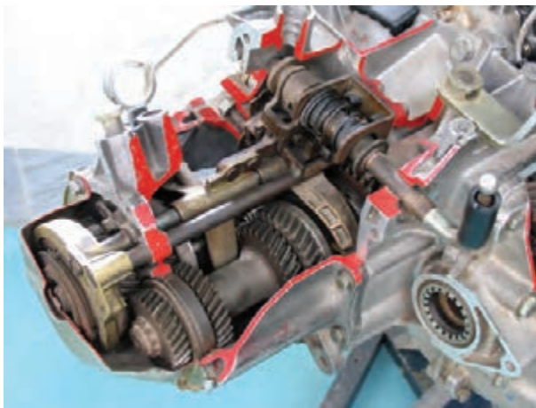
شکل ۱۶۲- جعبه دنده خودروی محرک جلو
