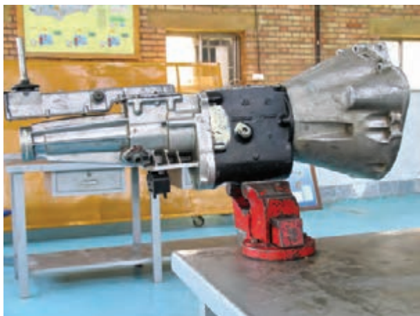
شکل ۱۶۳- جعبه دنده خودروی محرک عقب
