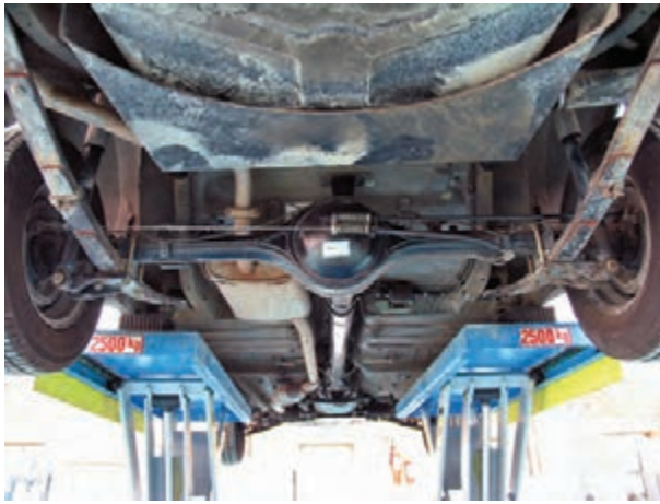
شکل ۳۱۵- دیفرانسیل در خودرو محرک عقب
