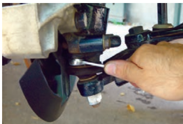
شکل ۳-۷۸- باز کردن سبک زیر کمک فنر
