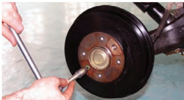
شکل ۱-۸۹ – باز کردن پیچ کاسه چرخ
