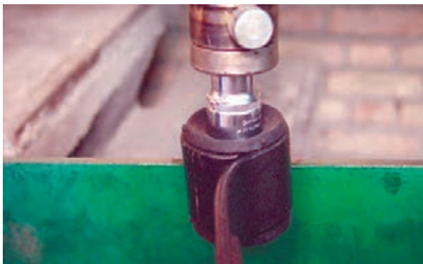
شکل ۳-۶۹- بوش لاستیکی فلزی محل اتصال شاه فنر
