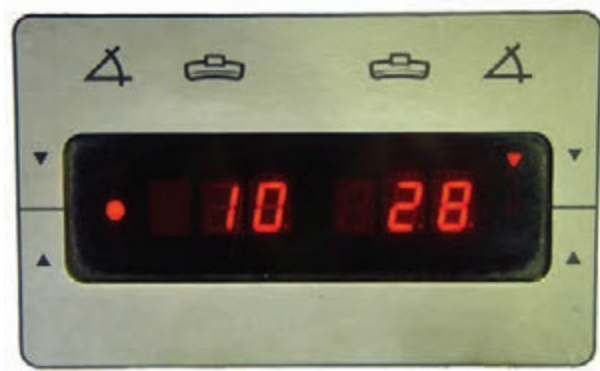
شکل ۲۳۷-۳- تعیین وزنه مورد نیاز در صفحه نشان‌دهنده
