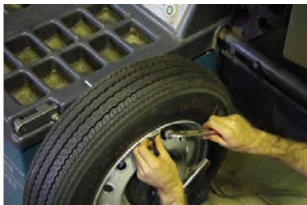
شکل ۲۳۸-۳- نصب وزنه روی قسمت بیرونی رینگ
