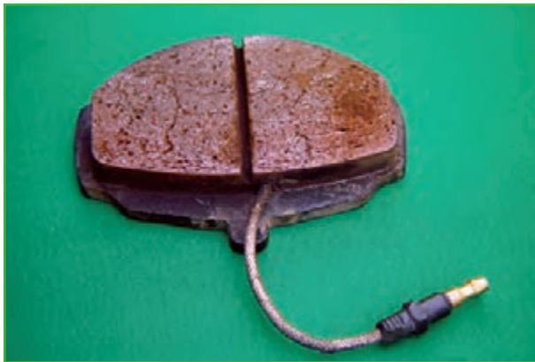
شکل ۱۱۲-۱- لنت ترمز دارای سیم هشدار
