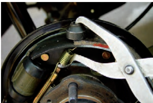
شکل ۱-۱۰۷- جازدن فنر بالایی کفشک
