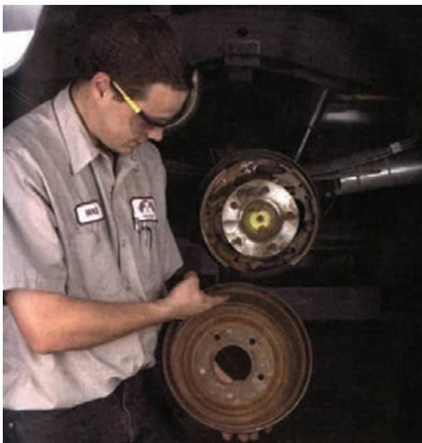
شکل ۹۶-۱- کنترل کاسه چرخ
