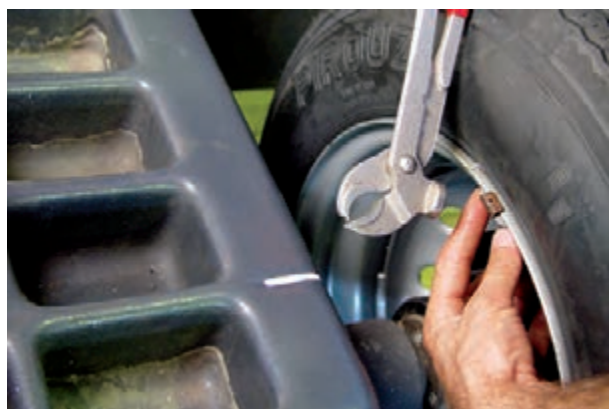
شکل ۲۳۹-۳- نصب وزنه روی قسمت داخلی رینگ
