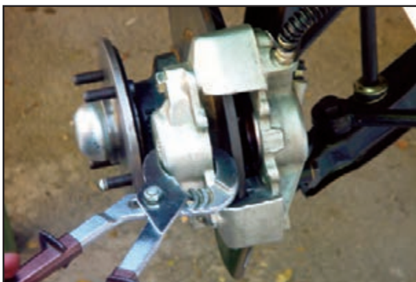
شکل ۱۱۴-۱- عقب راندن پیستون ترمز دیسکی
