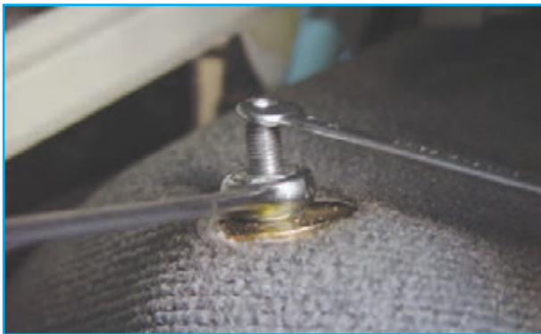
شکل ۳-۶۳- باز کردن مهره اتصال بالای کمک فنر
