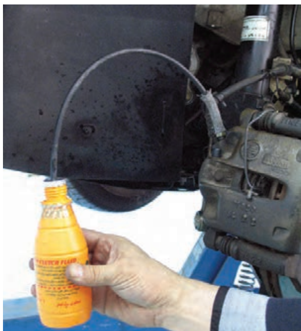
شکل ۱-۷۱- نصب لوله پلاستیکی روی پیچ هواگیری
