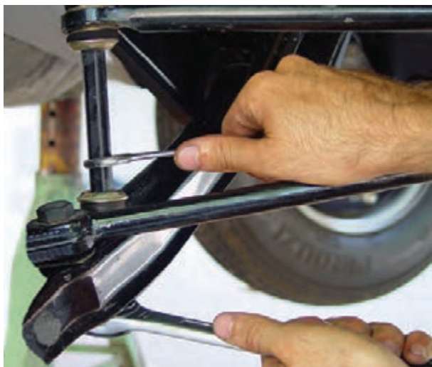
شکل ۳-۸۲- باز کردن میله رابط میله ضد غلتش (موج گیر)
