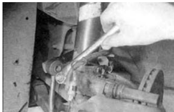
شکل ۱۱۸-۳- بستن پیچ نگه‌دارنده کمک فنر
