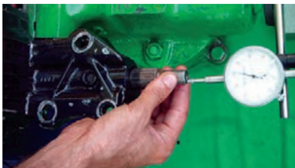
شکل ۷۰-۲- اندازه‌گیری لقی طول محور هزار خار
