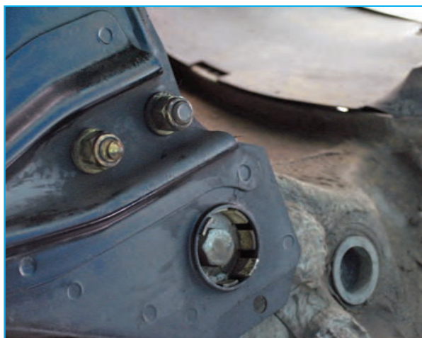
شکل ۳-۱۲۲- باز کردن پیچ‌های طبق
