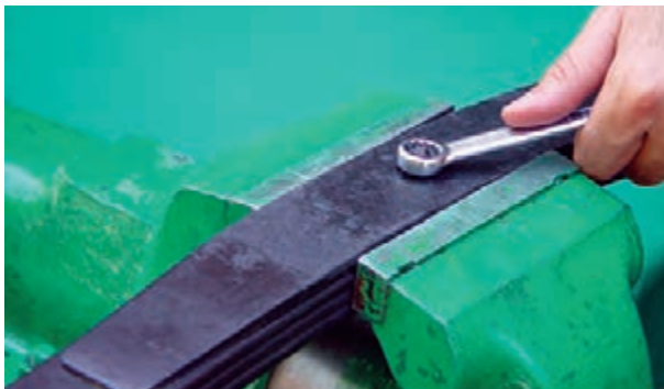
شکل ۳-۶۸- باز کردن پیچ مرکز فنرهای شمش
