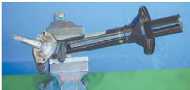
شکل ۳-۹۷- پوسته کمک فنر و محور چرخ
