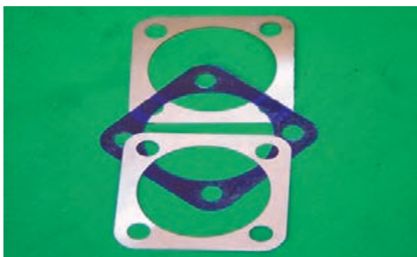
شکل ۶۷-۲- واشرهای فلزی بین لوله و بدنه جعبه فرمان
