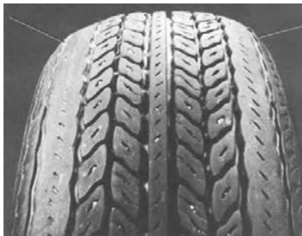
شکل ۲۱۴-۳- سایش در اثر رانندگی غلط (پیچیدن تند)
