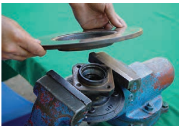
شکل ۳-۹۸- جدا کردن دیسک ترمز از تویی چرخ
