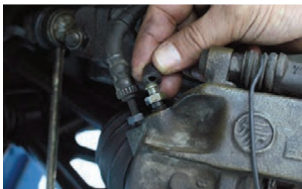
شکل ۱-۷۰- پاک کردن اطراف پیچ هواگیری
