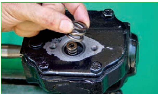
شکل ۲-۶۱- خارج کردن فنرها
