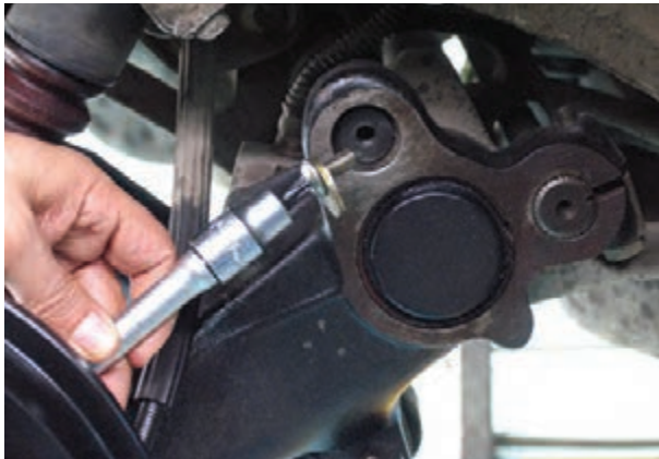
شکل ۱۷۶-۳- نصب واشر فشار و بیج‌های انتهای میله‌ها
