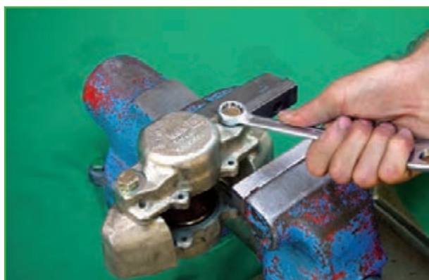
شکل ۱-۱۲۰- باز کردن پیچ های کالیپر
