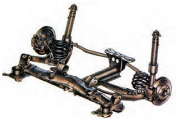
شکل ۳-۴۸- سیستم تعلیق مستقل عقب با چرخ‌های متحرک
