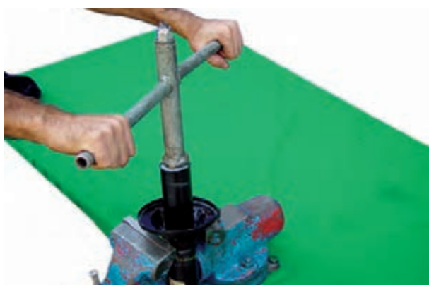
شکل ۳-۹۱- باز کردن مهره نگه‌دارنده کمک فنر
