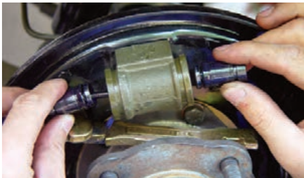
شکل ۹۴-۱- خارج کردن پیستون‌ها
