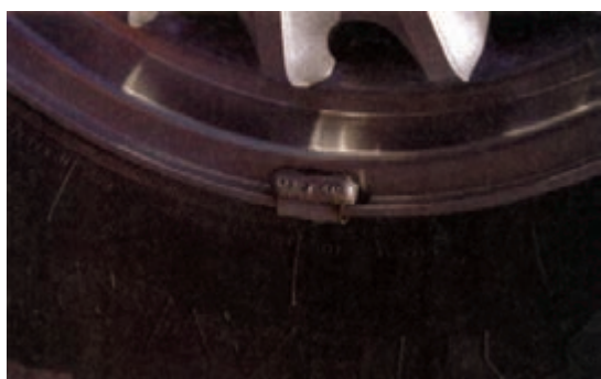
شکل ۳-۲۳۱- نصب وزنه روی رینگ
