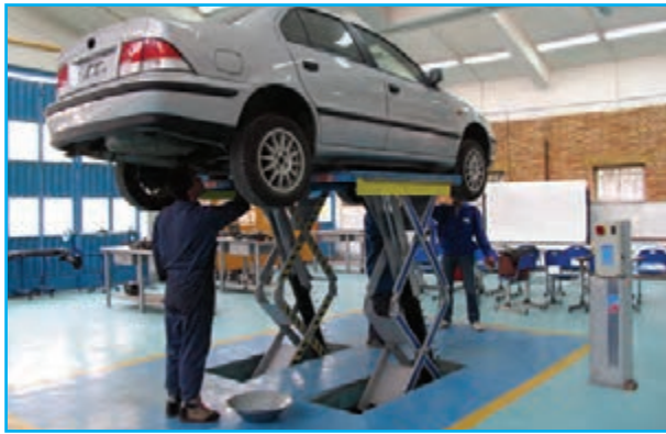
شکل ۲-۴۶- استقرار خودروی روی بالابر
