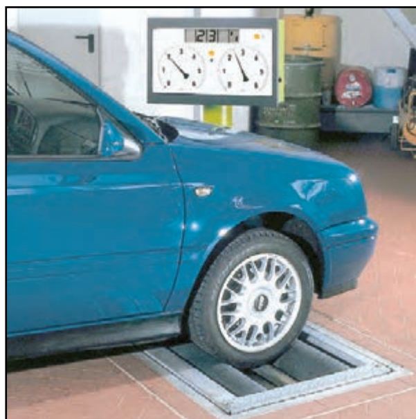
شکل ۱-۷۴- دستگاه آزمایش دینامیکی ترمز
