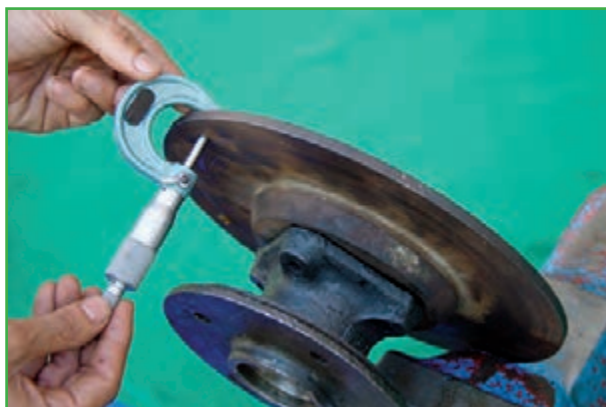
شکل ۱-۱۲۴- اندازه‌گیری ضخامت دیسک
