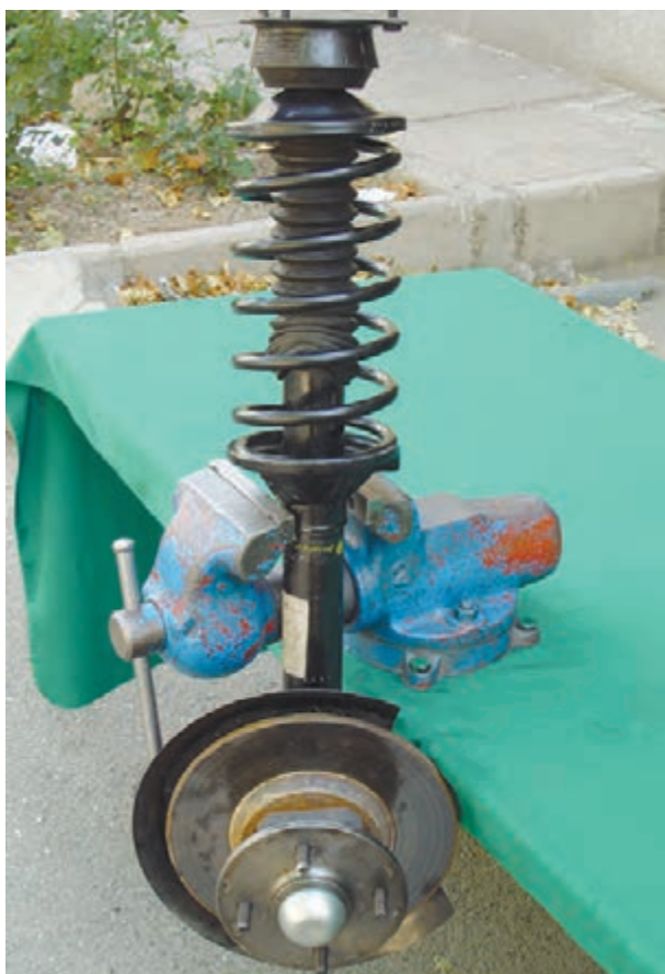
شکل ۳-۸۰ بستن مجموعه فنر و کمک فنر به گیره
