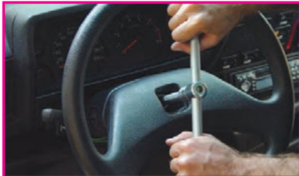
شکل ۲-۳۳- پیاده کردن فلکه فرمان
