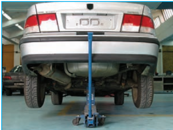
شکل ۱۵۶-۳ تنظیم ارتفاع و کنترل رام لوله‌ای
