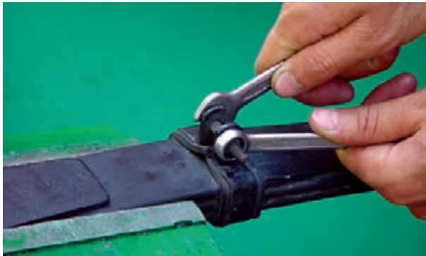
شکل ۳-۶۷- باز کردن بست‌های مجموعه فنر شمش
