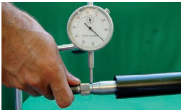
شکل ۶۹-۲- اندازه‌گیری لقی جانبی میل فرمان
