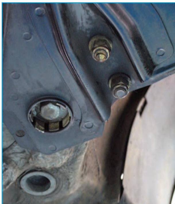
شکل ۱۳۰-۳- پیاده کردن میل موج گیر بلند
