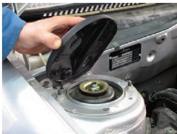
شکل ۳-۱۰۳ برداشتن پوشش بالای تکیه‌گاه کمک فنر
