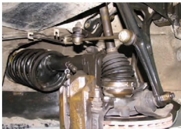
شکل ۱۳۱-۳- نصب میل موج گیر کوتاه
