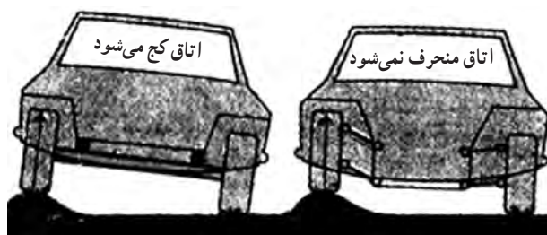
شکل ۱۰-۳- تفاوت عملکرد سیستم تعلیق یک پارچه و مستقل
