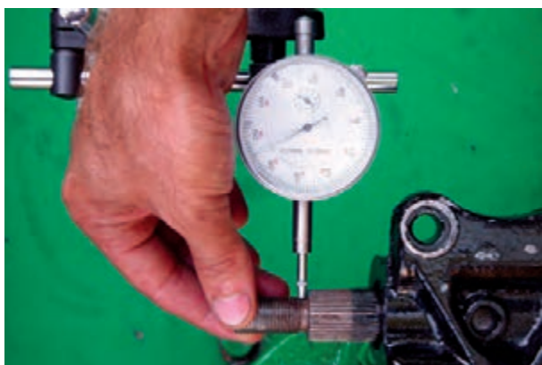
شکل ۷۱-۲- اندازه‌گیری لقی جانبی محور هزار خار
