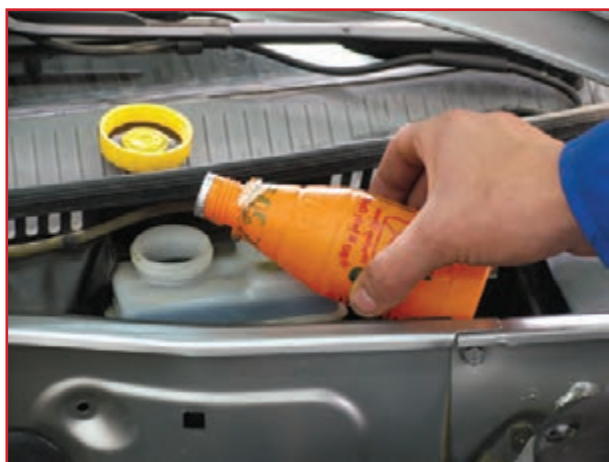
شکل ۱-۶۸- برکردن مخزن مایع ترمز تا حداکثر (MAX)
