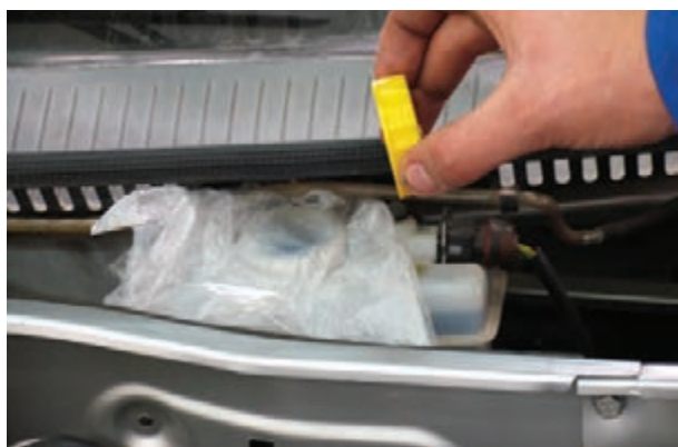
شکل ۱۳۸-۱- مسدود کردن در مخزن مایع ترمز
