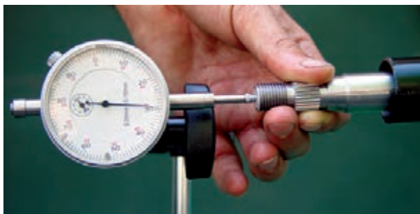
شکل ۶۸-۲- اندازه‌گیری لقی طولی میل فرمان
