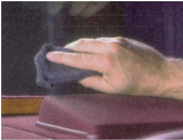
شکل ۲۲-۳- تمیز کردن محل قطع شده‌ی المنت حرارتی
