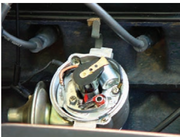
شکل ۵۵-۱۰- راستای چکش برق به سمت سیلندر یک
