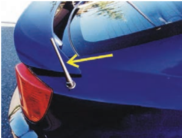
شکل ۱۶-۵- باز شدن میله‌ی آنتن
