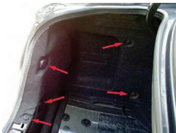
شکل ۲۰-۵- خارهای پلاستیکی کاور صندوق عقب
