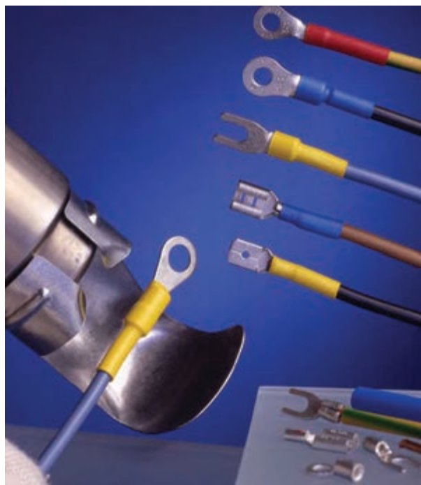
شکل ۳۳-۵- عایق کاری سر سیم‌ها
