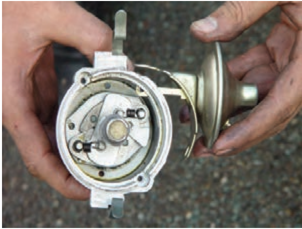
شکل ۳۱-۱۰ جدا کردن مجموعه‌ی آوانس خلئی
