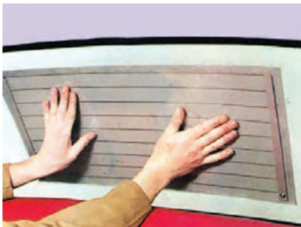
شکل ۹-۳- نحوه چسباندن المنت حرارتی
