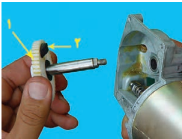
۱- چرخ دنده ۲- بادامک محرک زائده پلاتین
