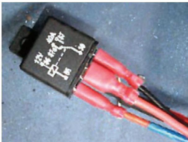
شکل ۴۷-۸- رله‌ی مورد استفاده در مدار الکتریکی پمپ بنزین
