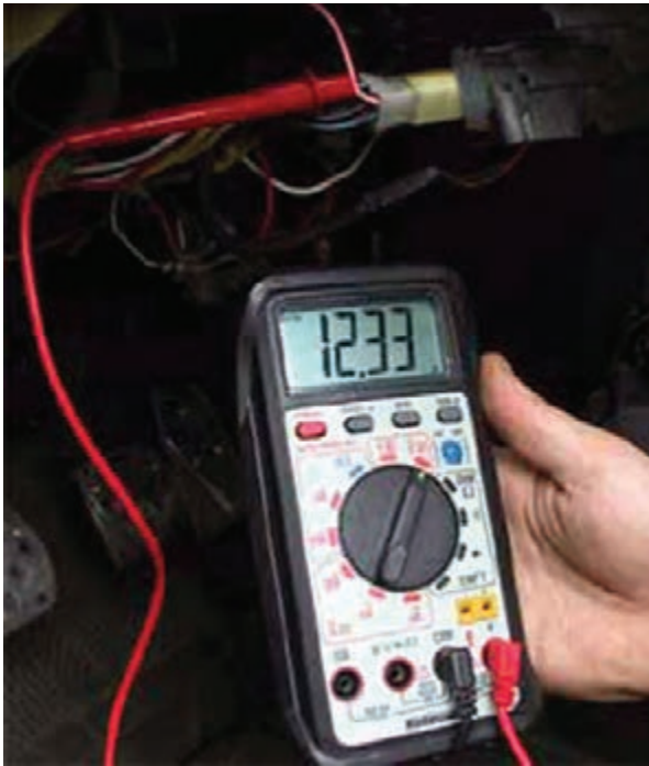
شکل ۲۸-۱۱- اندازه‌گیری ولتاژ در ترمینال ورودی سوئیچ
