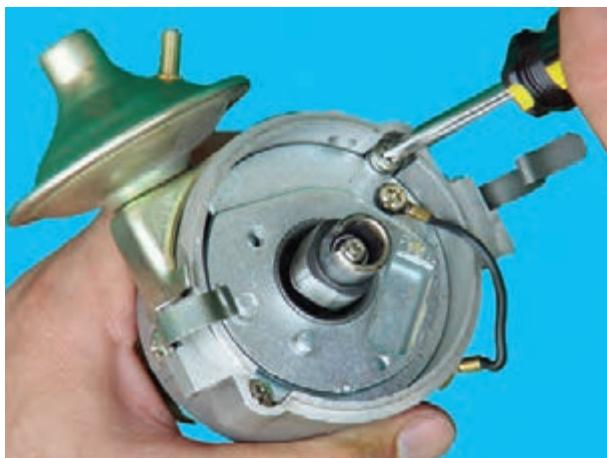
شکل ۱۹-۱۰- باز کردن پیچ‌های صفحه‌ی دلکو
