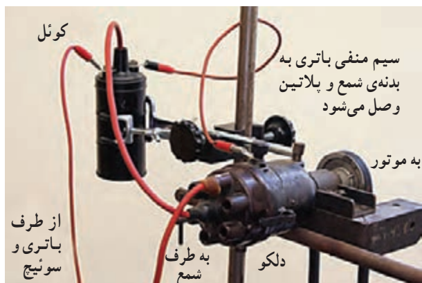
شکل ۱۴۴-۲- مدار شبیه‌سازی شده‌ی سیستم جرقه‌زنی
