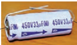
الف - توجه به قطب‌های خازن الکترولیتی
