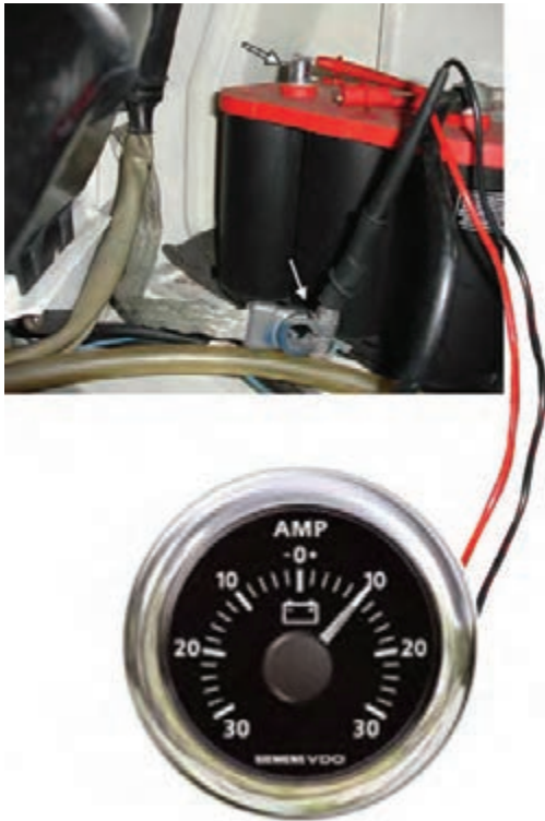
شکل ۱-۵۲ اتصال آمپر متر به صورت سری
