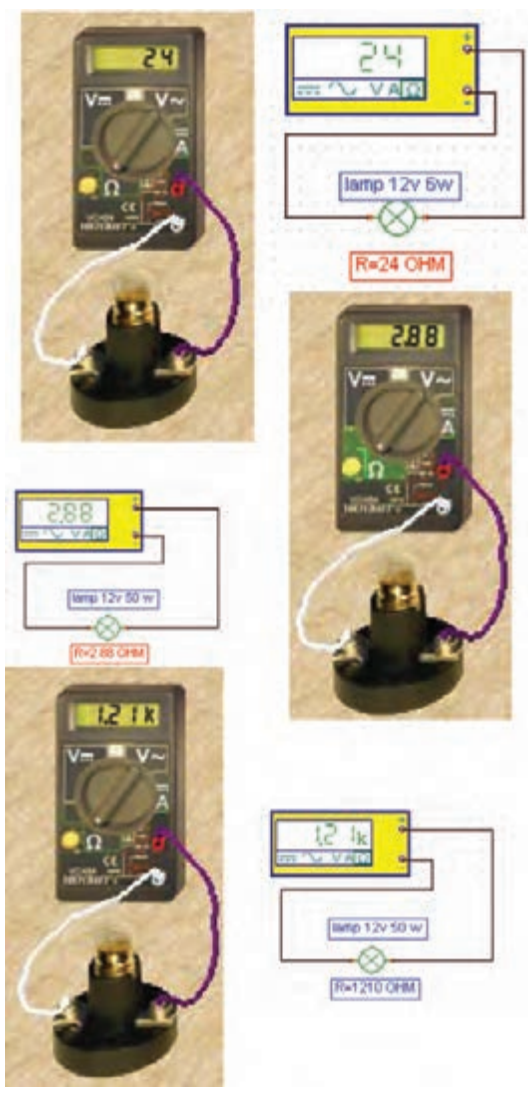
شکل ۸۹-۲- اندازه گیری مقاومت لامپ‌های روشنایی
