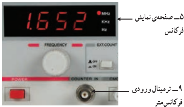
شکل ۲-۱۰۳- فرکانس متر و ترمینال ورودی آن
