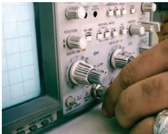
شکل ۱۱۴-۲ نحوه‌ی اتصال BNC به اسیلوسکوپ
