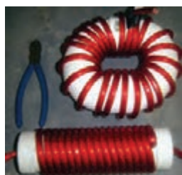
سلف پیچیده شده روی قرقره بدون هسته
