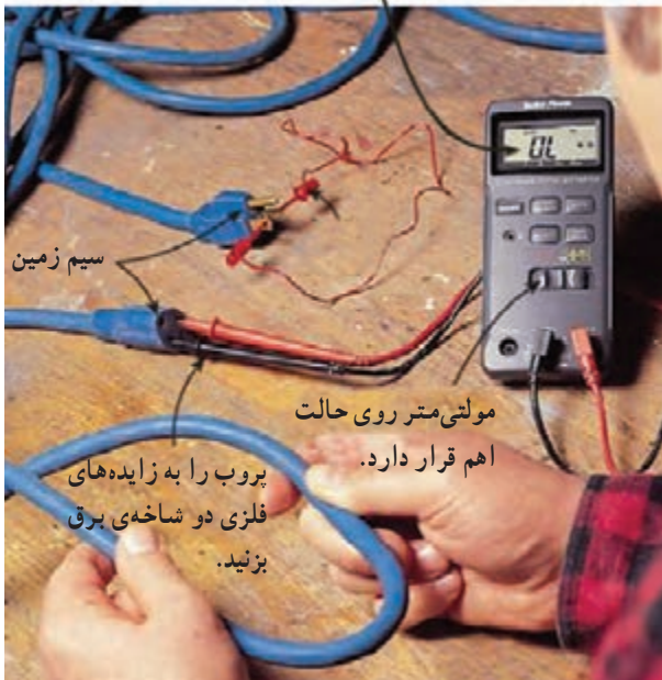
شکل ۲-۸۰ - آزمایش سیم رابط برق دستگاه.
