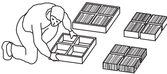
شکل ۵۶-۱ قالب زنی خمیر و ساخت خشت
