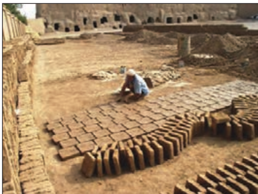
شکل ۱-۵۴ خشت خام (ساخت آجر به روش دستی)
