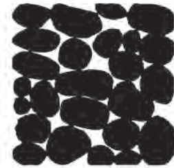
بتن خشن با دانه بندی درشت و متخلخل
