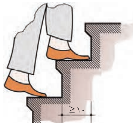
شکل ۱۶-۳ کوچک‌ترین اندازه‌ی کف پله در پله‌های پیچ
