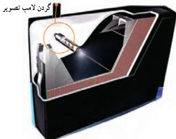
شکل ۱-۳- لامپ تصویر رنگی و گردن آن
