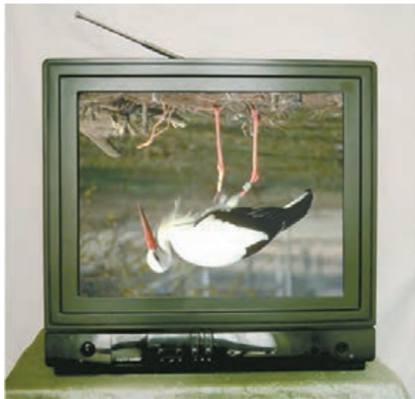
شکل ۲-۹۸- تصویر وارونه روی صفحه‌ی تلویزیون
