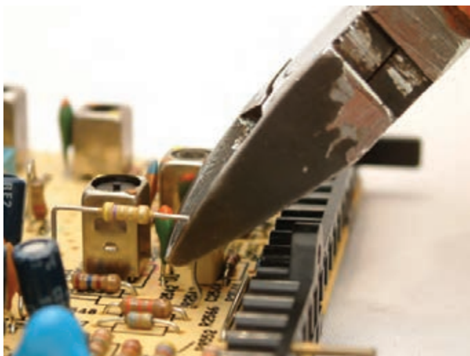
شکل ۲-۲۹- قطع کردن پایه بلند المان‌ها برای ایجاد عیب
