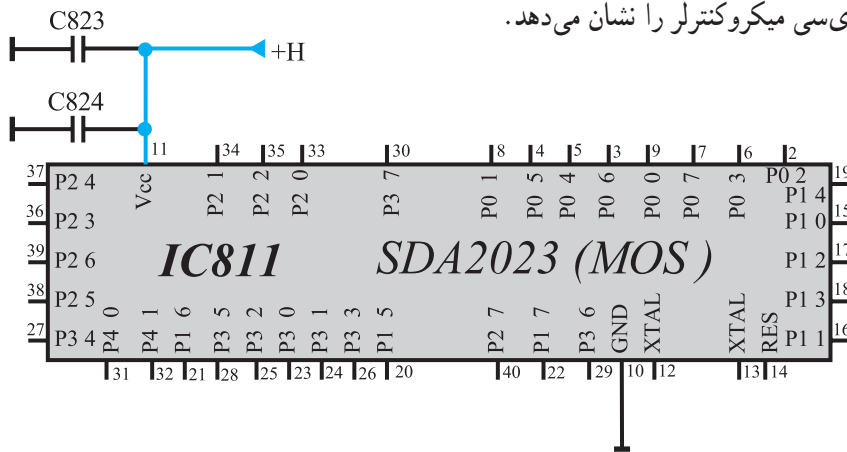
شکل ۲-۵۰- پایه ۱۱ آی سی میکروکنترلر
