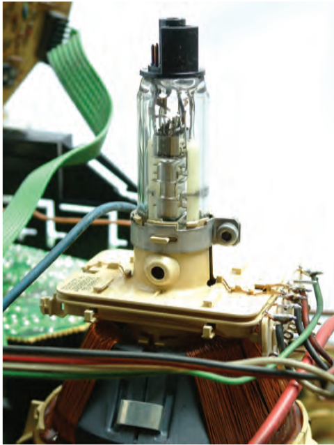
شکل ۱-۷۱-الف - شکل لامپ تصویر و پایه‌های آن
