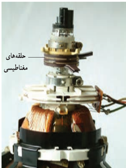
شکل ۱-۹۸ حلقه های مغناطیسی روی گردن لامپ
