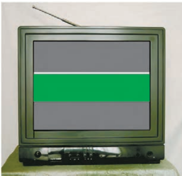
شکل ۲-۱۱۶- تصویر تلویزیون وقتی C518 قطع است.
