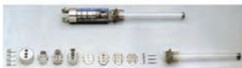
شکل ۱-۷- اجزای یک تفنگ الکترونی
