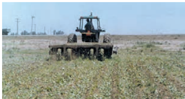
شکل ۱۲-۵- برداشت ماشینی سرزنی چغندر
