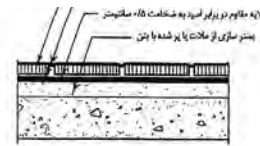
اجرای کف پوش کاشی
