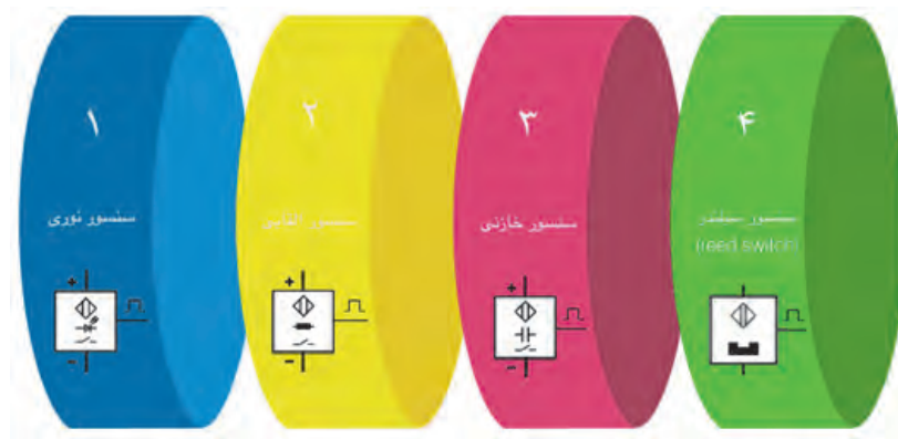
انواع سنسورها در الکتروهیدرولیک
