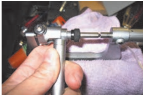
مرحله ۳- کالیبره کردن ساعت در میکرومتر و خواندن اختلاف (لقی)
