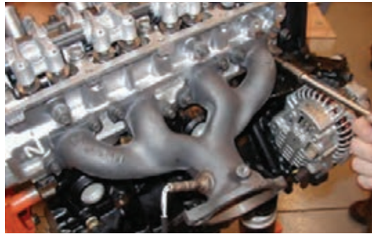
(الف) باز کردن پیچ‌های مانیفولد خروجی
