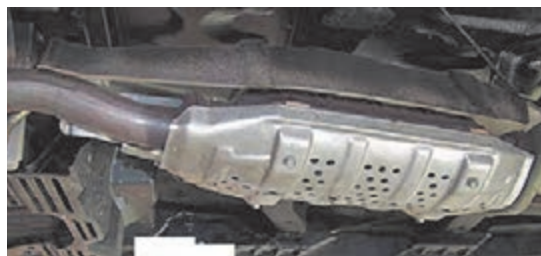
شکل ۲۵-۳- جای بسته شدن سپر حرارتی در سیستم اگزوز
