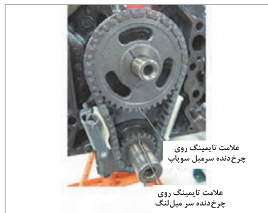
ب) مکانیزم حرکتی زنجیری در موتور OHV
