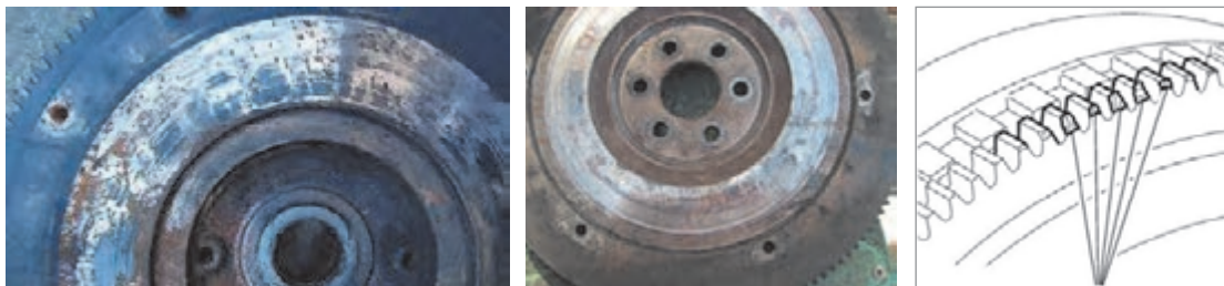
(ب) خرابی جای پیچ و سطح تماس با سیستم کلاچ
