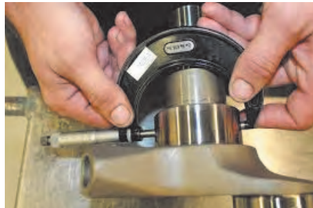
مرحله ۲- اندازه گیری قطر لنگ یا محور ثابت
