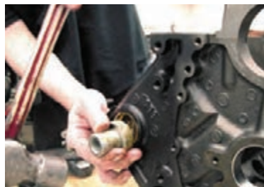
ب) ابزار مخصوص و روش جازدن پولکی
