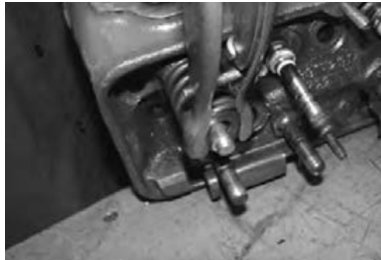
شکل ۱-۶۵- تنظیم گیره نگهدارنده بشقابک سوپاپ در فنر سوپاپ جمع کن
