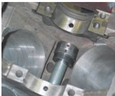
شکل ۱۴۱-۲- تعویض بوش‌های میل سوپاپ
