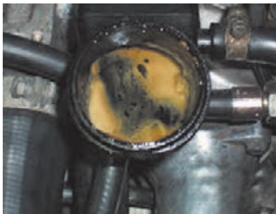
شکل ۹۵-۲- نفوذ روغن در مایع خنک کاری
