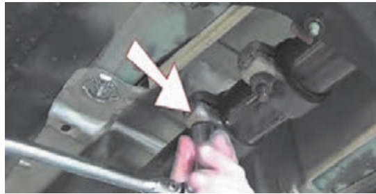
الف) بررسی اتصالات پیچ و مهره ای
