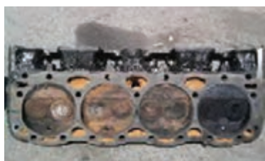
پ) ورود مایع خنک کننده به سرسیلندر
