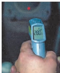
ب) دمای خوانده شده کاتالیزور در آغاز روشن شدن خودرو
