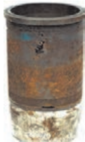
شکل ۲-۹۳- نشتی از محل‌های گوناگون بوش سیلندر و واشر سرسیلندر و بالای بوش
