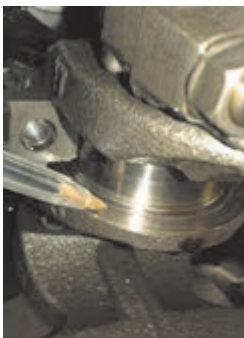
شکل ۲-۱۱۲- بررسی سایش جانبی میل لنگ
