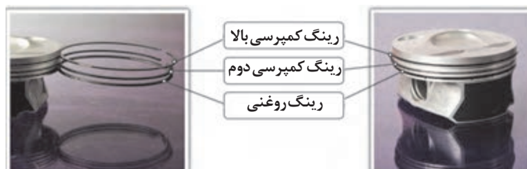
شکل ۲-۴۵- پیستون سبک با ارتفاع کم با دو رینگ کمپرسی و یک رینگ روغنی
