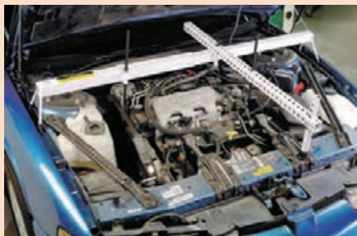
شکل ۱-۵۵- استفاده از نگهدارنده موتور
