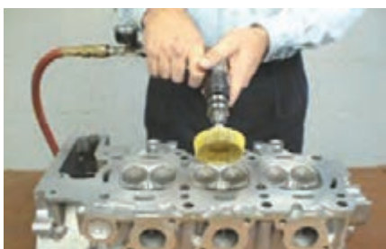
ب) استفاده از دریل پنوماتیکی با سنباده در رسوب‌زدایی اتاق احتراق و کف سرسیلندر شکل ۱-۶۹- روش‌های رسوب‌زدایی
