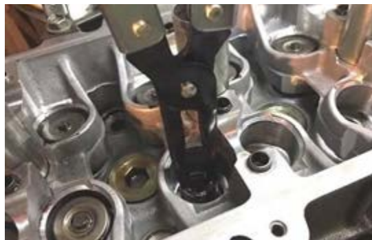
شکل ۱-۶۶- بیرون آوردن کاسه نمد سوپاپ‌ها از روی راهنمای سوپاپ
