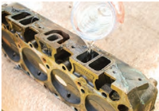
ب) نشستی سنجی سوپاپ‌ها با مایع در راهگاه سوپاپ‌ها
