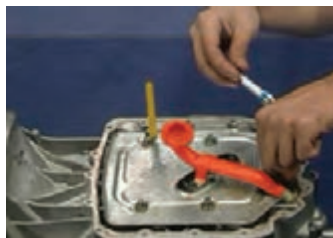
ب) بازکردن صافی روغن ورودی به پمپ
