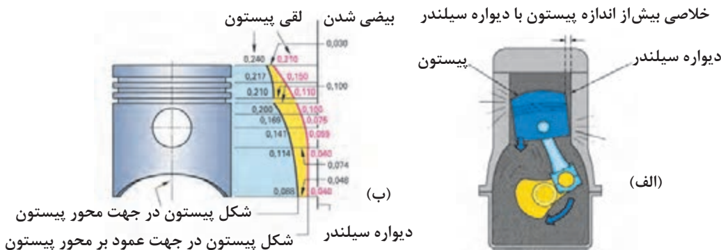
شکل ۲۸-۲- لقی پیستون در یک پیستون بیضی شکل
