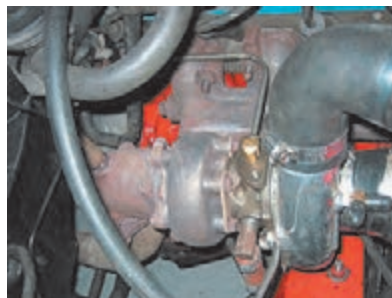
الف) جای بسته شدن توربو شارژر روی موتور
