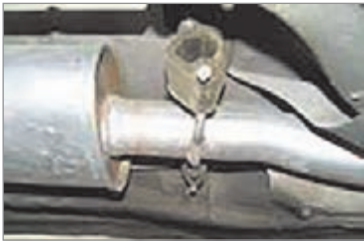
ب) بررسی بست‌های نگهدارنده سیستم اگزوز
