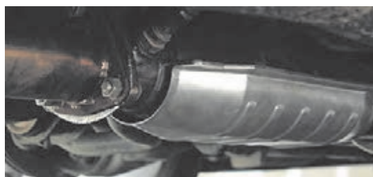
شکل ۲۵-۳- جای بسته شدن سپر حرارتی در سیستم اگزوز
