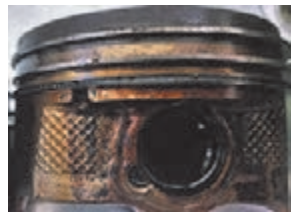
پ) کربن‌گرفتگی بیش از اندازه رینگ‌ها
