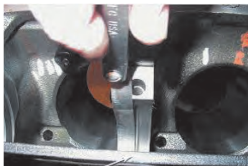
شکل ۲-۱۰۳- بررسی همراستا بودن یاتاقان‌ها
