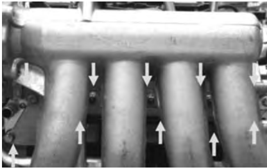
(ب) باز کردن پیچ‌های مانیفولد ورودی
