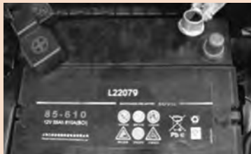
شکل ۱-۵۱- جدا کردن بست باتری
