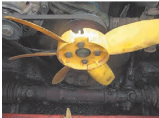
الف) وجود شکستگی یا ترک پره‌ها
