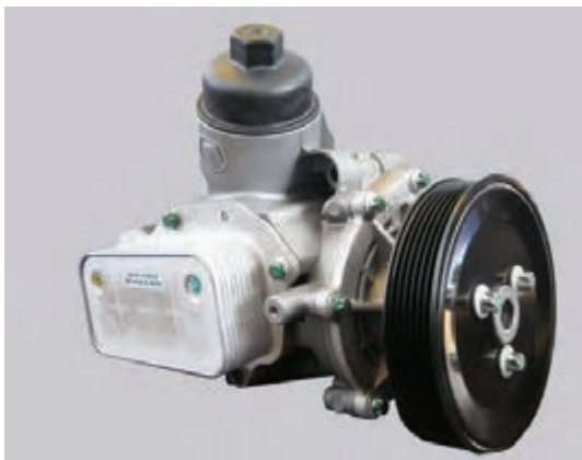
شکل ۴-۸- خنک کن روغن موتور ملی EF7
