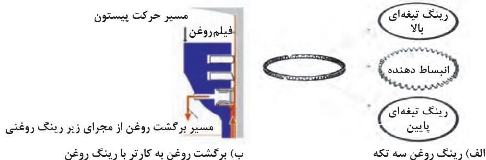
شکل ۲-۴۶- عملکرد رینگ روغن سه تکه
