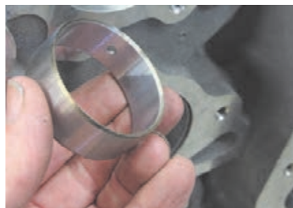
شکل ۲-۸۷- یاتاقان های میل سوپاپ
