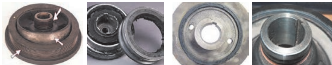
الف) پاره شدن لاستیک میان دو حلقه
