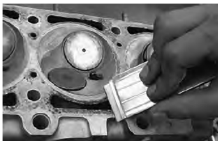
الف) رسوب‌زدایی کف سرسیلندر و اتاق احتراق
