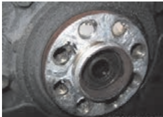
شکل ۲-۱۱۶- خرابی رزوه سر میل لنگ
