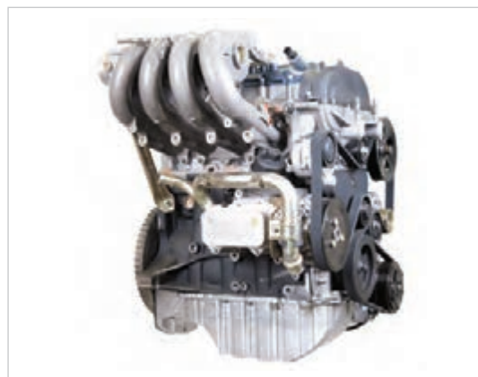
شکل ۴-۸- خنک کن روغن موتور ملی EF7
