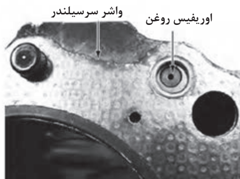
شکل ۴-۱۲- اوریفیس مدار روغن کاری
