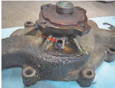
ت) شکستگی پایه‌ها
