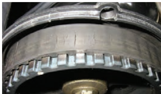
(الف) ترک داشتن محیط تسمه تایم نشانه نیاز به تعویض فوری تسمه است.
