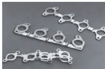
ب) واشرهای آب بندی مانیفولد خروجی و سرسیلندر
