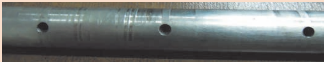
شکل ۸۹-۱- کانال روغن در میل اسبک
