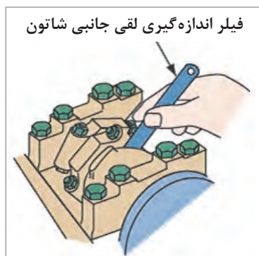
شکل ۱۳۶-۲- اندازه گیری لقی طولی
