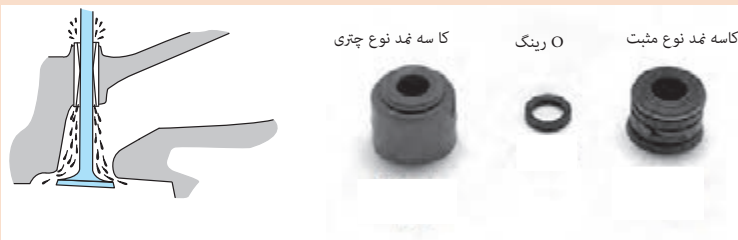
شکل ۱-۷۸- انواع کاسه نمد گاید و روش جازدن
