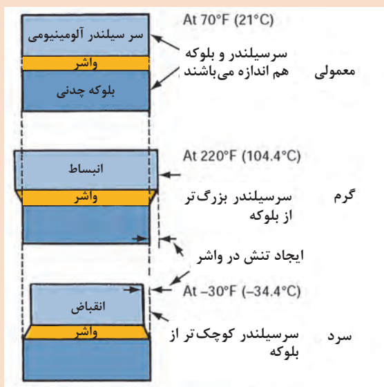
شکل ۹۲-۱- اثر جنس واشر سرسیلندر
