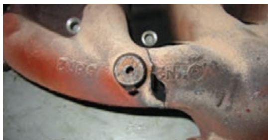
(پ) شکستگی مانیفولد خروجی (چدنی)
