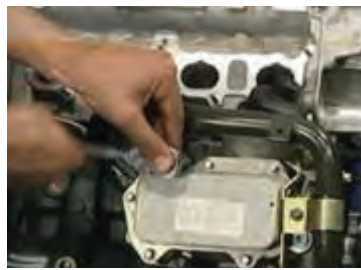
ح) بستن خنک‌کن روغن روی موتور
