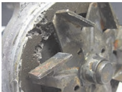
ج) خرابی بلبرینگ و خوردگی داخلی
