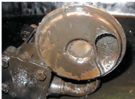
شکل ۴-۲۳- صافی پمپ روغن جرم گرفته
