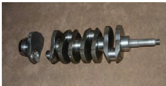
شکل ۷۲-۲- بریدن میل لنگ
