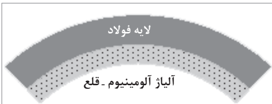
شکل ۲-۷۹ - آلیاژهای لایه یاتاقان
